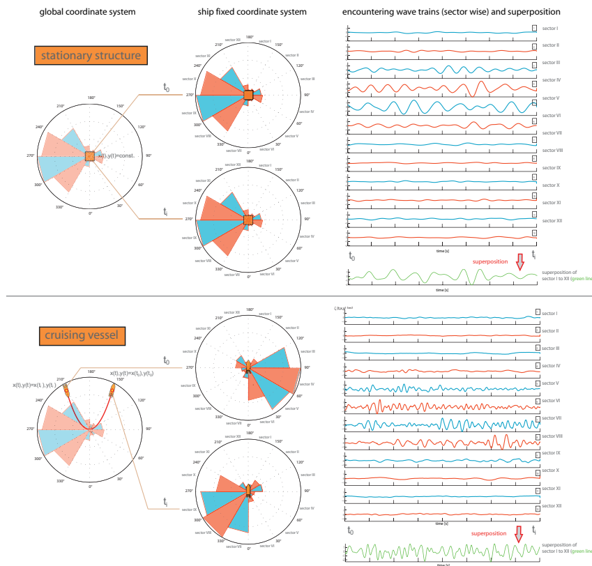
Abb. 27: In Sektoren unterteiltes globales Koordinatensystem (links); in Sektoren unterteiltes schiffsfestes Koordinatensystem (mitte), sektorenweise berechnete Begegnungswellenzüge
