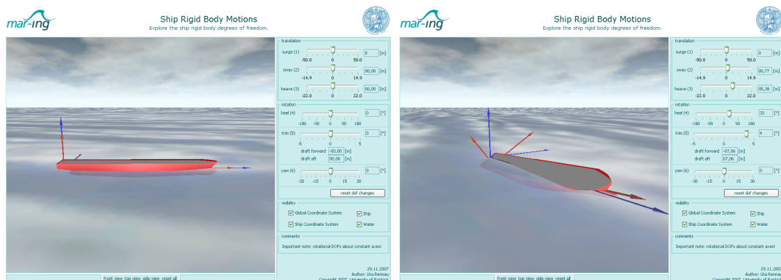
Abbildung 37: Screenshots der Bewegungsfreiheitsgrade eines Schiffes
