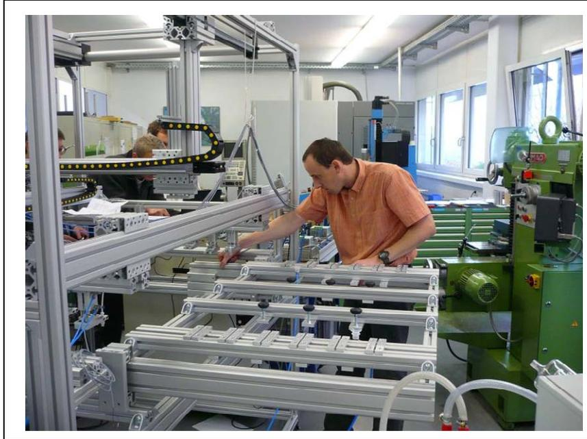
**Abbildung 36: Maschine zur automatisierten Befüllung von Farbstoffsolarmodulen während des Aufbaus in der Werkstatt des Fraunhofer IAO**
