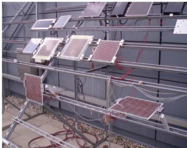
**Abbildung 41: Photo eines Outdoorteststandes am Fraunhofer ISE zur Vermessung von Farbstoffsolarmodulen (im Vordergrund) unter verschiedenen Orientierungen**
