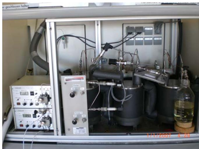
**Abbildung 25: kontinuierlicher Reaktor für die Synthese von PMIM I**
