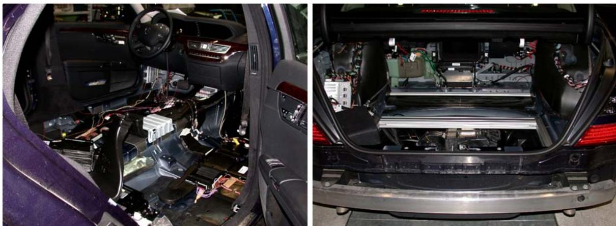
**Abbildung 1: Hardwareintegration in Versuchsträger während des Werkstattaufbaus (Innenraum – linkes Bild, Kofferraum – rechtes Bild).**
