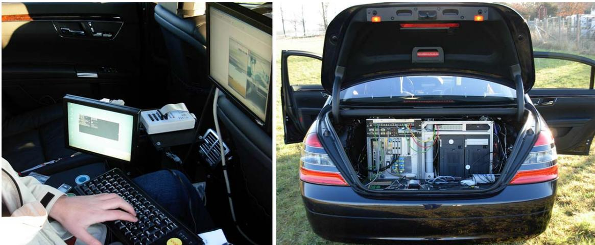
**Abbildung 2: Hardwareintegration in Versuchsträger nach Abschluss der Arbeiten.**
