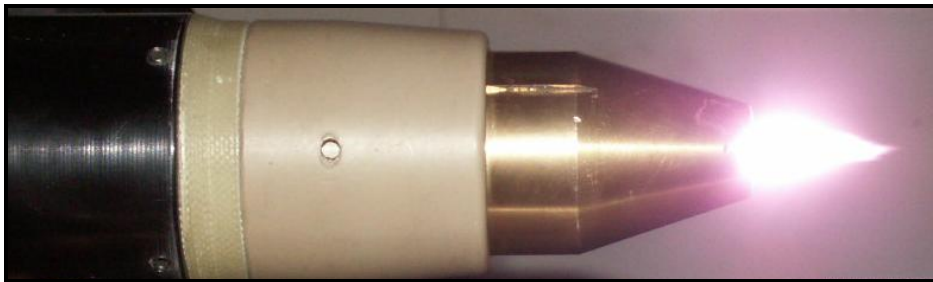
Bild 69: Brenner PB-S75 WI mit indirektem Lichtbogen und neuen Komponenten
