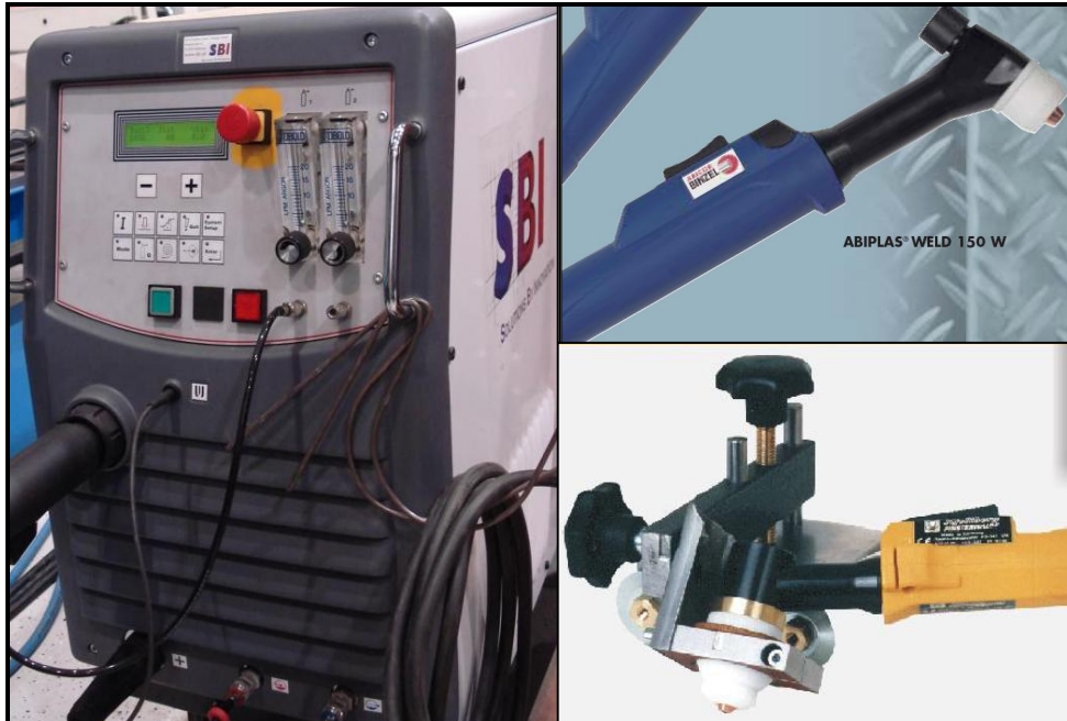
Bild 48: Stromquelle Fa. SBI, Plasmabrenner Fa. Abicor Binzel und Räderwagen Fa. Kjellberg
