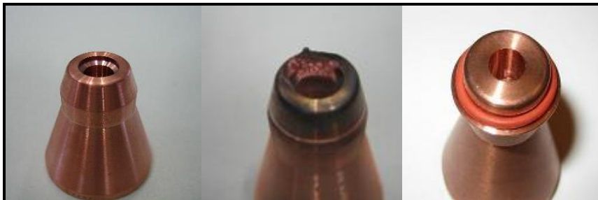
Bild 70: Neue Düsen mit ersten Auswaschungen und deren Weiterentwicklung
