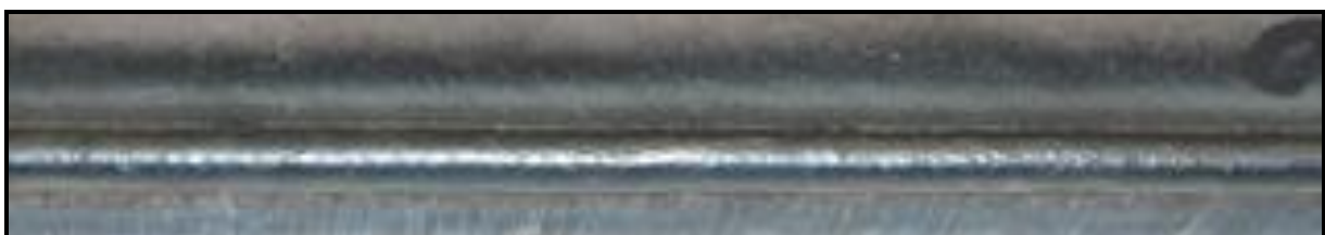
Bild 65: Kantenumschmelzung mittels gepulsten Lichtbogen mit R=2\text{ mm} und v=1,5\text{ m/min}
