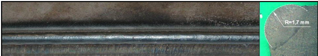
Bild 64: Ergebnis der optimierten Brennerstellung
