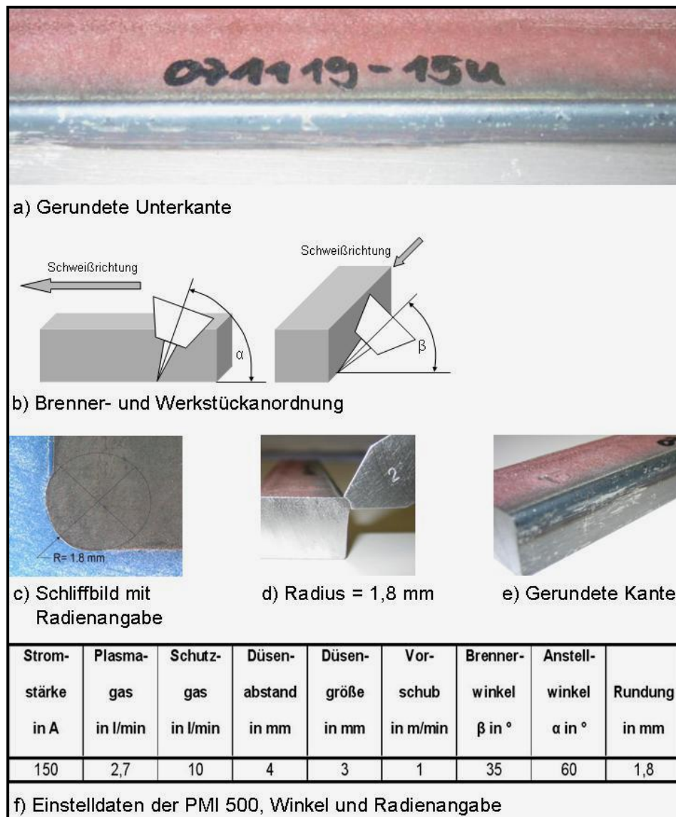
Bild 58: Mittels Plasmaschweißverfahren gerundete Unterkante
