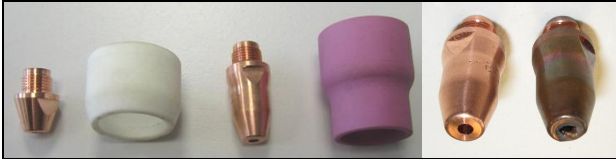
Bild 76. Unterschied der Düsengeometrie mit Verschmelzung an den langen Düsen
