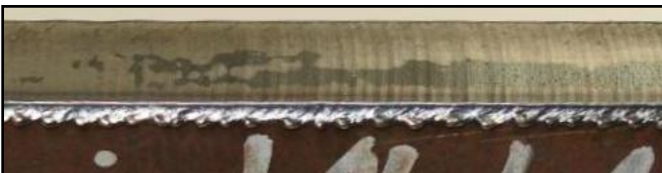
Bild 43: Fasenschnitt mit festhaftender Schmelze
