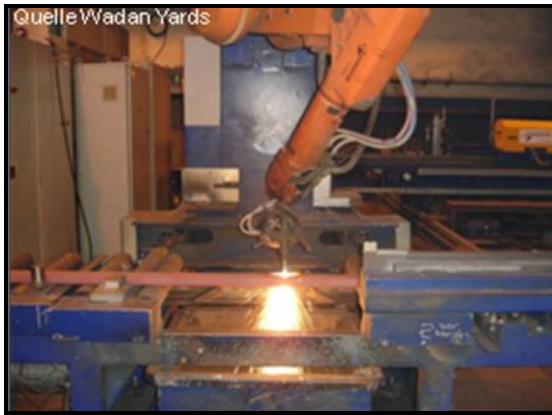
Bild 10: Profilzuschnittroboter mit Autogen- oder Plasmabrenner
