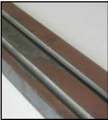
Bild 42: Kantengeometrie beim Fugenhobeln vor dem Schnitt
