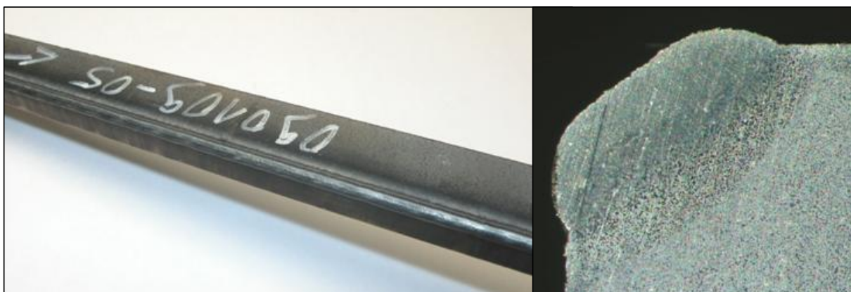
Bild 67: Kantenumschmelzung mit fallender Bearbeitungsrichtung
