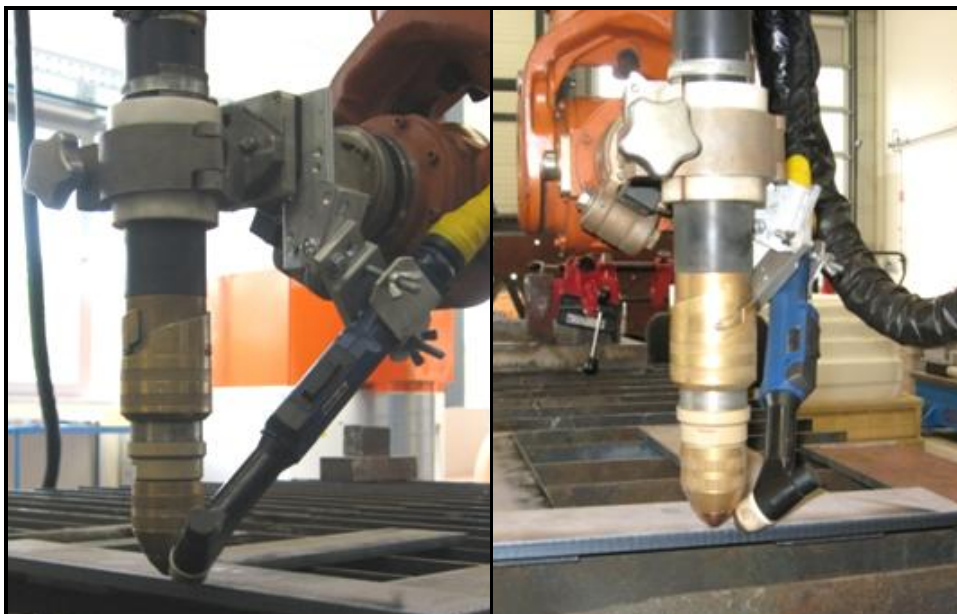
Bild 51: Schneid- und Schweißbrenner in einer Aufnahme
