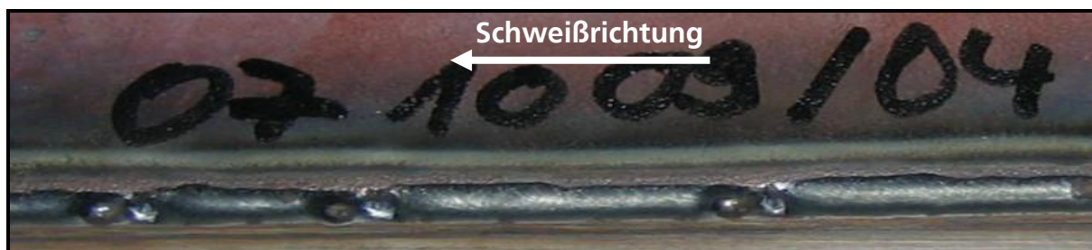
Bild 55: Unregelmäßigkeiten durch zu große kinetische Energie des Plasmagases
