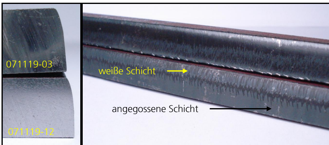
Bild 29: Stickstoffschnitt: Querschnitte (l.), Schnittflächen (r.)
