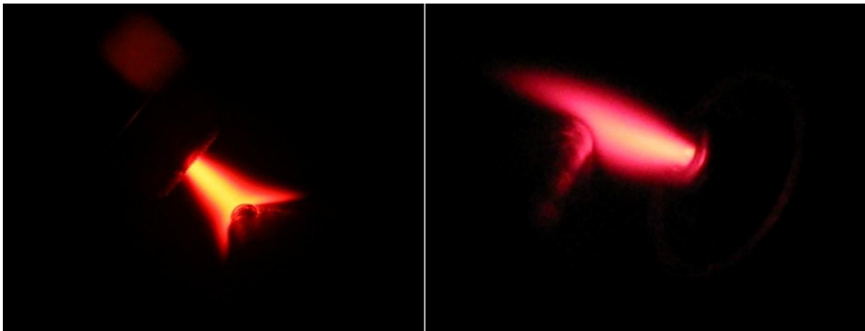
Bild 62: Plasmalichtbogen bei Brennerwinkel \alpha : 45^\circ (li.), 110^\circ (re.)
