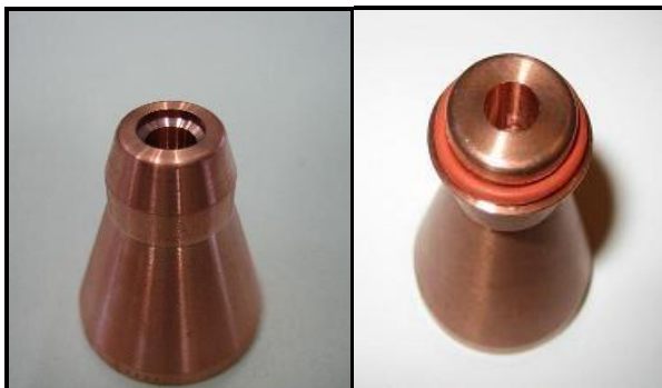
Bild 49: Links alte Düsenform und rechts neue Düsenform
