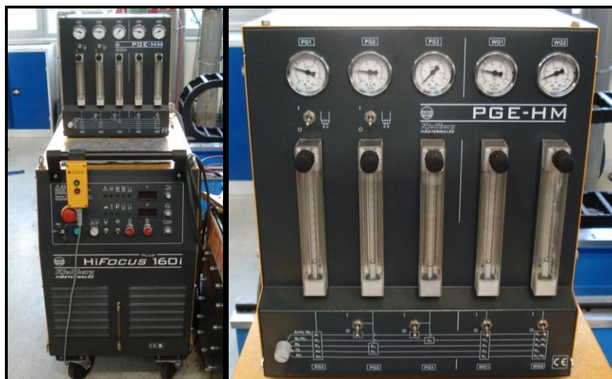
Bild 14: Inverter HiFocus 160i (l.); Plasmagaseinstelleinheit (r.)
