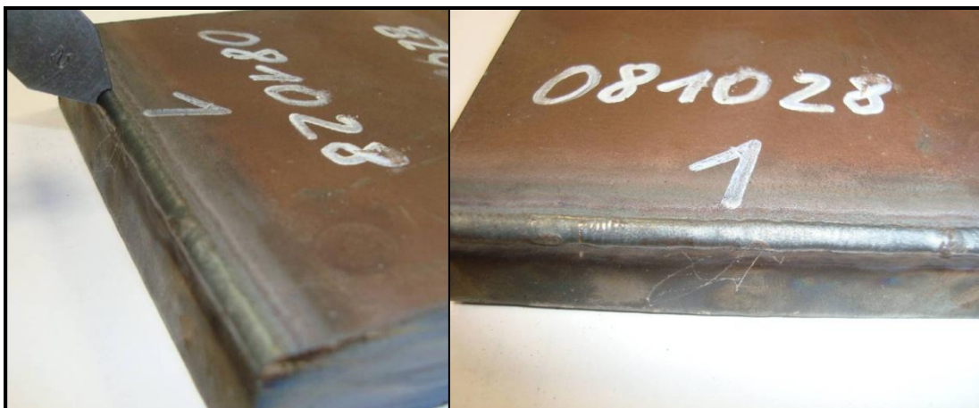
Bild 71: Kantenumschmelzung mittels indirektem Lichtbogen
