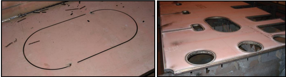
Bild 8: Mannlochausschnitt mit Stegen und geräumtes Zuschnittblech auf Kammpalette
