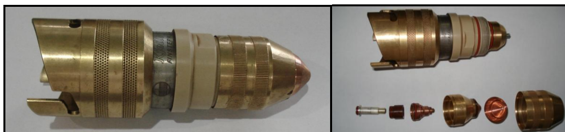
Bild 15. Plasmaschneidbrenner PerCut 170 mit Verschleißteilen
