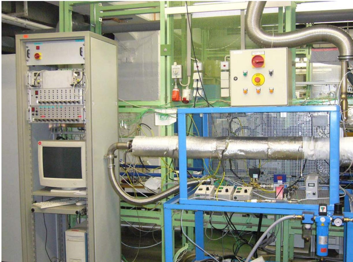
**Abbildung 2:** Versuchsanlage zum Messen von Light Off und Light-Out katalytisch beschichteter Vollkörper in realen Baugrößen und zur Durchführung von Heißgastests.
