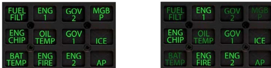
Abbildung 27: Burn-In Simulation; links: kein Burn-In; rechts: Simulierter Burn-In
