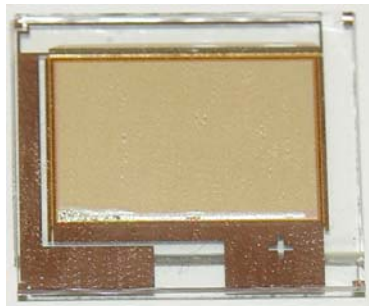
Abbildung 65: Zerstörung von OLEDs aufgrund von zu hohen Strömen; links: Kurzschluss durch Fertigungsfehler; rechts: Betrieb mit zu hohem Strom
