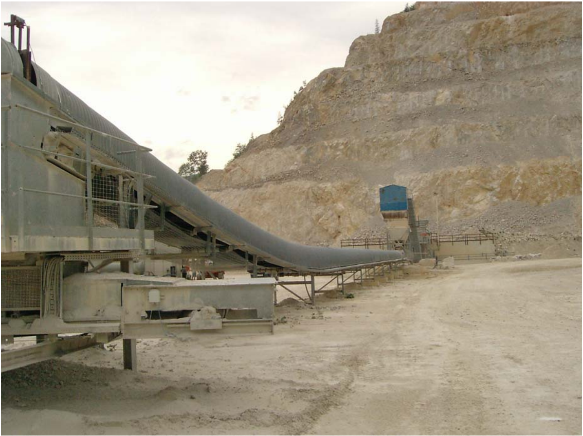
Abbildung 18: Primärbrecher mit nachgeschaltetem Förderband
