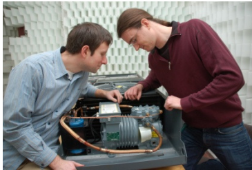
Abbildung 93: EU Projekt In-MAR: Aktiver Tilger dämpft Lärm eines Kompressors (Fraunhofer LBF)
