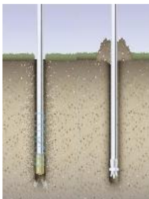
Abbildung 100: Vergleich zwischen Geojetting (links) und dem klassischen Verfahren (rechts) ( www.portal-management.eu )
