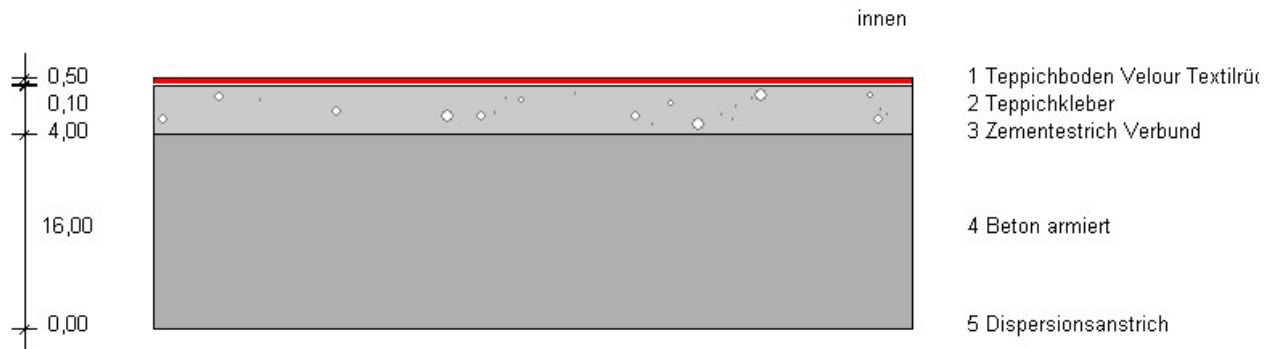
FuD4 Innendecke mit Teppichboden (Regelgeschoss)
