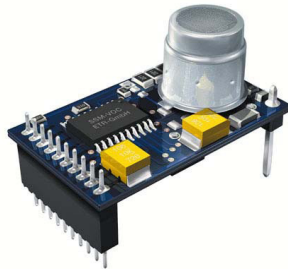
Abbildung 82: LUQAS-Smart Sensor Modul (25 mm x 15mm x 15mm), (archiv.ensan.de)
