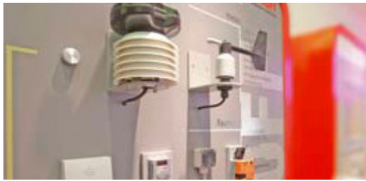
Abbildung 85: Wetterstation für die Gebäudeautomation ( www.beckhoff.at )
