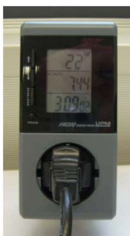
Abb. 6.3.7.- 1: Energieverbrauch-Messgerät (Strom) und ermittelte Stand-by Durchschnittswerte
