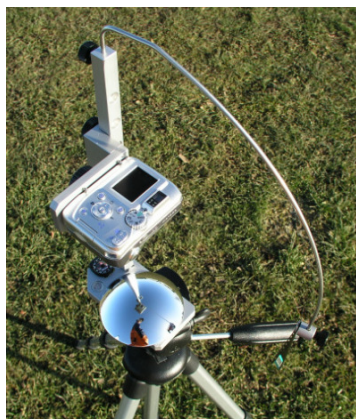
Abbildung 3.12.2- 155 System zum aufzeichnen eines realen Horizonts (Meteotest)
