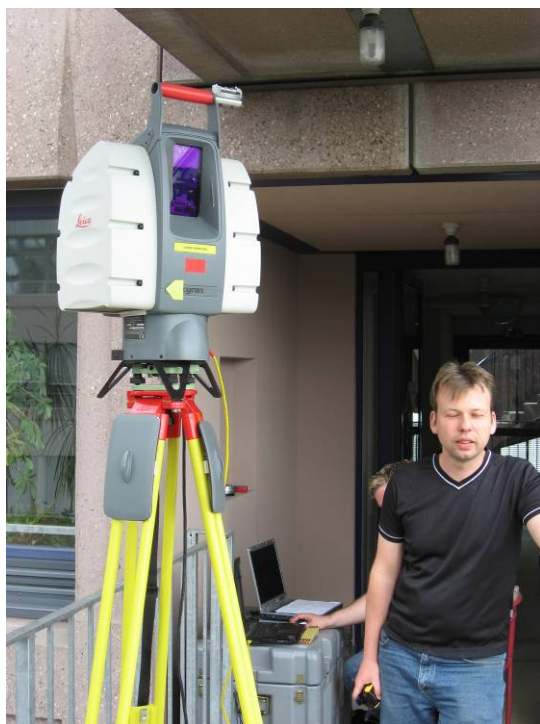
Abb. 2.A-07: HDS 3000 mit Reichweite bis 150 m
