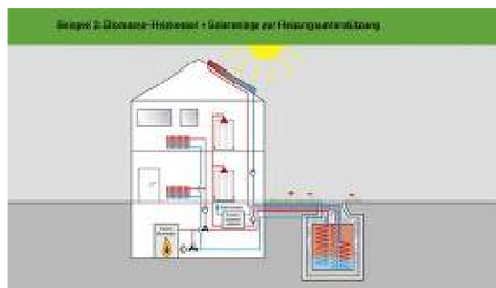
Abbildung 39: Einbindung eines Pufferspeichers (Mall GmbH)
