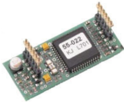
Abbildung 84: Steuergerät DALI (www.osram.de)
