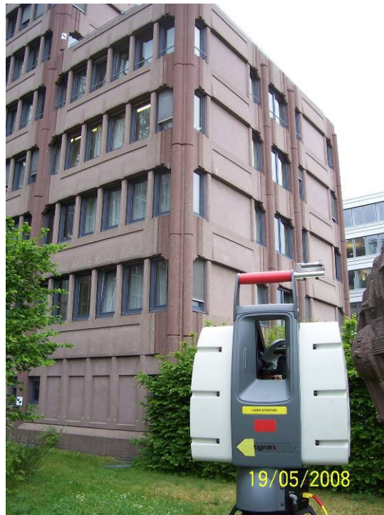
Abb. 2.A-02: Laserscanner Leica - HDS 3000
