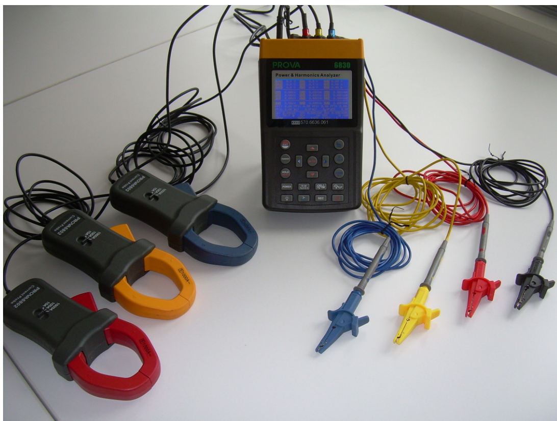
Abbildung 3.3.1.6- 5 Strom-Messgerät PCE-830, PCE Group
