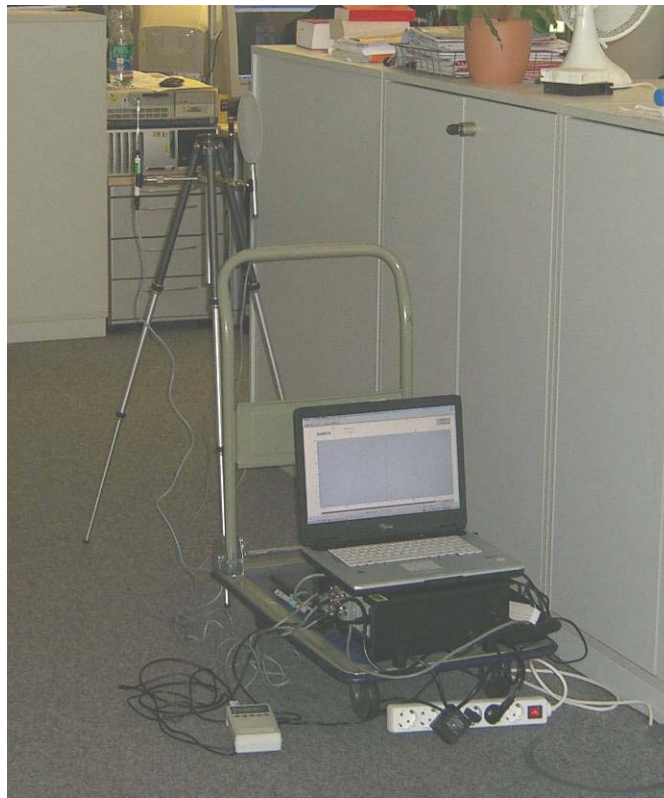
Bild 4. Messaufbau zur Ermittlung des PMV und PPD-Indexes am Arbeitsplatz.
