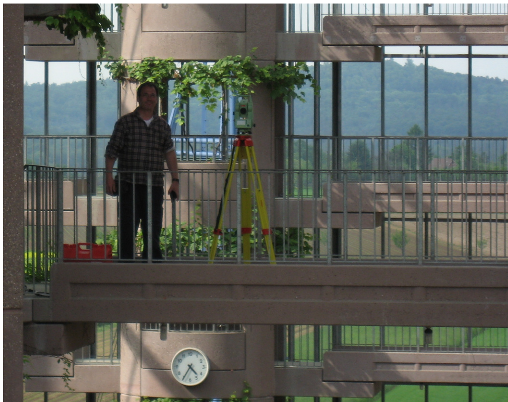
Abb. 5.3.2.2-02: tachymetrische Einmessung der Zielzeichen – zum Aufbau des Referenznetzes
