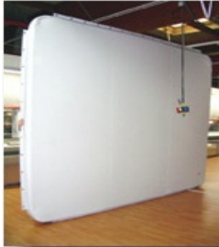
Abbildung 92: Mobiler aufblasbarer Schallschirm (Fraunhofer IBP)
