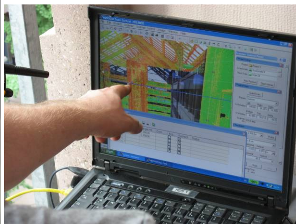
Abb. 5.3.2.2-04: Echtzeit-Verfolgung der gescannten Bereiche am Laptop
