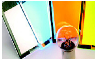
Abbildung 55: Organische Leuchtdioden als Flächenstrahler (www.siemens.com)
