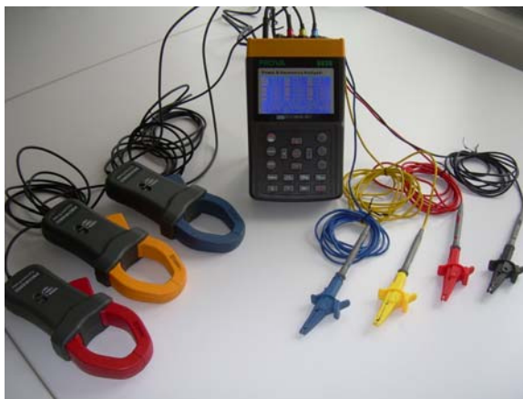
Abb. 6.3.6.- 3: Strom-Messgerät PCE-830 und Ergebnis mit resultierender Betriebszeit
