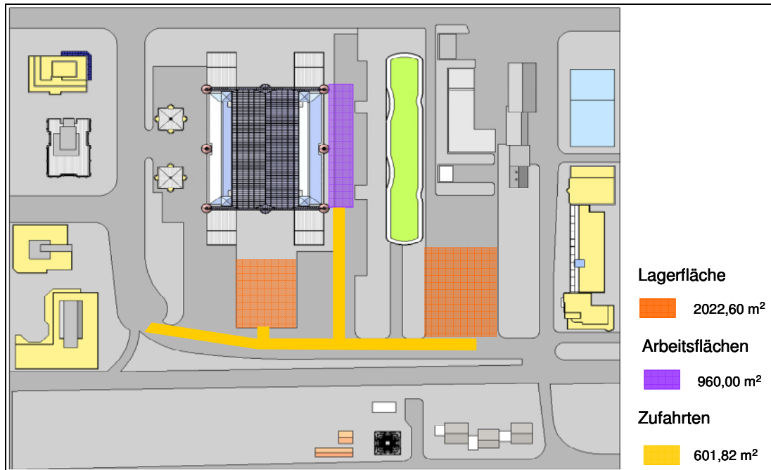
Abb. 5.1.5.2-3: Virtuelle Baustelle; Ableitung, Abstimmung und Darstellung der Baustelleneinrichtung, hier am betrachteten Beispiel der Fassadensanierung Züblin Haus
