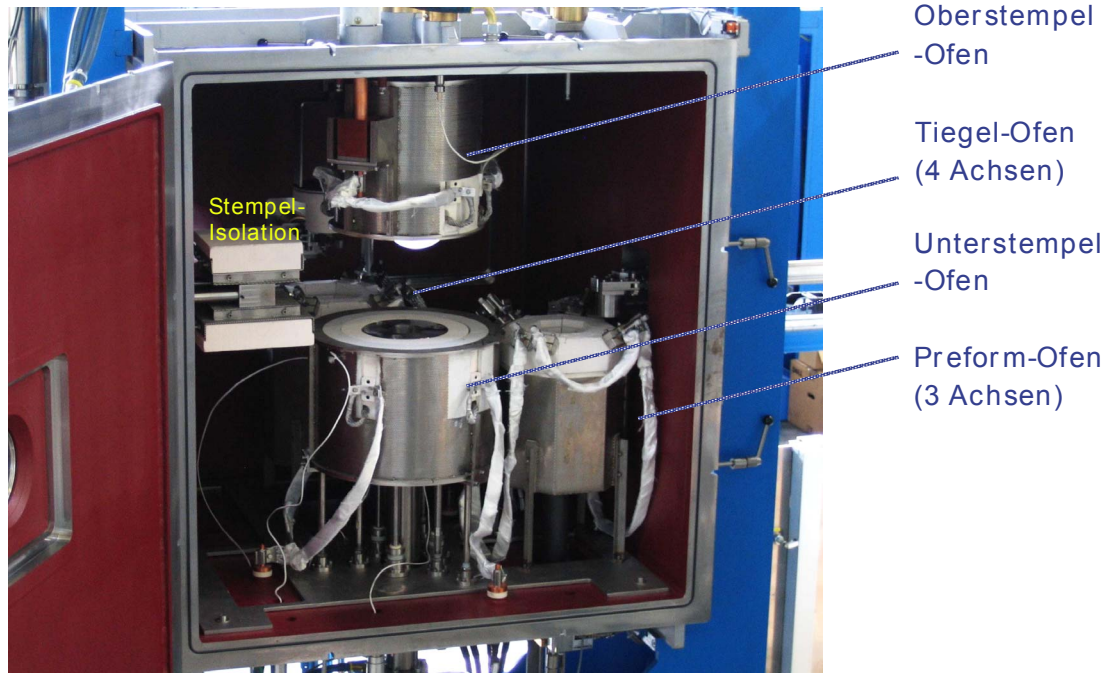
Abb. 73: Innenansicht des Vakuumbehälters
