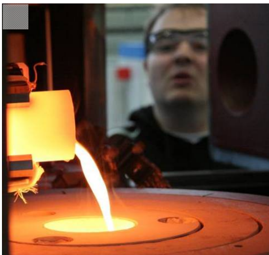
Abb. 104: a) Eingießen der Schmelze in der HTSC-Anlage b) Erster Abguss auf der HTSC-Anlage
