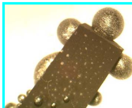
Abb. 82: Schnellsintern von PIM-Biegeprüfkörper-Abschnitten aus MMC (18Ni350 + 15 Vol.-% Al 2 O 3 ), modifizierter FAST-Sint-Prototyp
