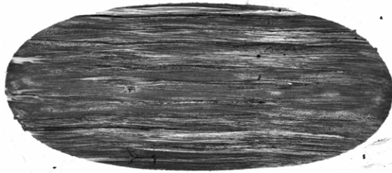
Abb. 84: 2,1 x 1,3 mm Verschleißspur auf der Maraging Scheibe
