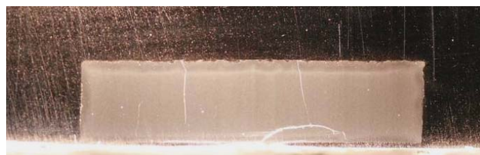
Abb. 102: WCo (Ni-Binder) Inlay umgegossen mit Maraging Stahl
