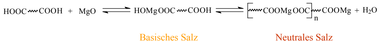
Gleichung 1: Verdickungsreaktion der SMC-Matten
