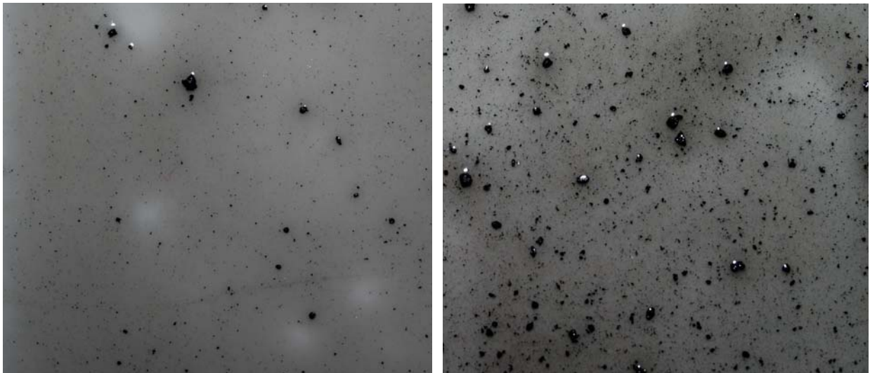
Abb. 138: Agglomeratbildung bei unterschiedlichen Füllgraden an CNT, links: \omega = 0.05\% rechts: \omega = 0.10\%
