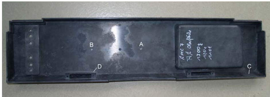
Abb. 62: Probeentnahmestellen aus einer Jungheinrich Batterieabdeckung/ Stapler (Class A; SMC 7; leitfähig/ Hohlglaskugelrezeptur)
