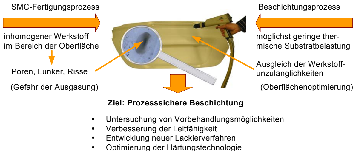
Abb. 1: SMC als inhomogener und problembehafteter Werkstoff
