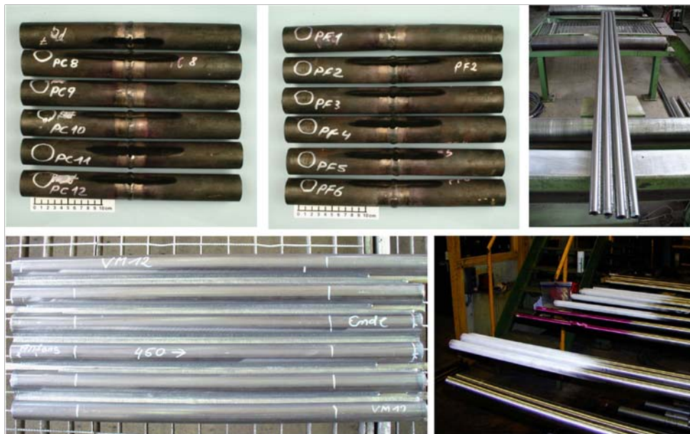
Bild 7.1: Kesselrohre und deren Schweißungen; Werkstoff: VM12-SHC
