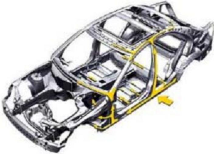
Bild 61. Lastpfade in die Karosserie beim Seitenaufprall [Kreuzinger05]
