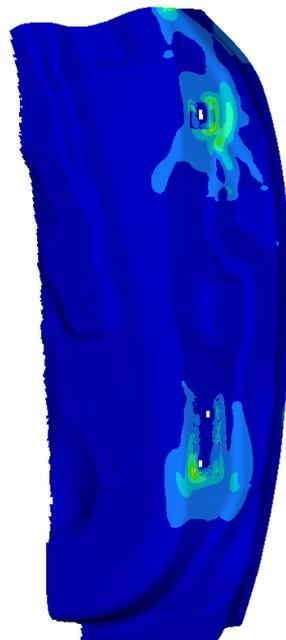
Bild 104. Von-Mises-Vergleichsspannung im Innenblech-Scharnier
