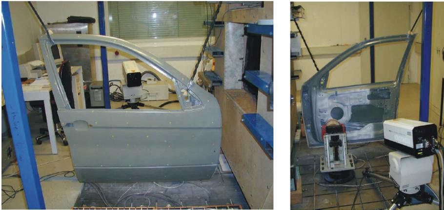
Bild 62. Messaufbau zur Schwingungsuntersuchung einer Fahrzeugtür [Rümmler]
