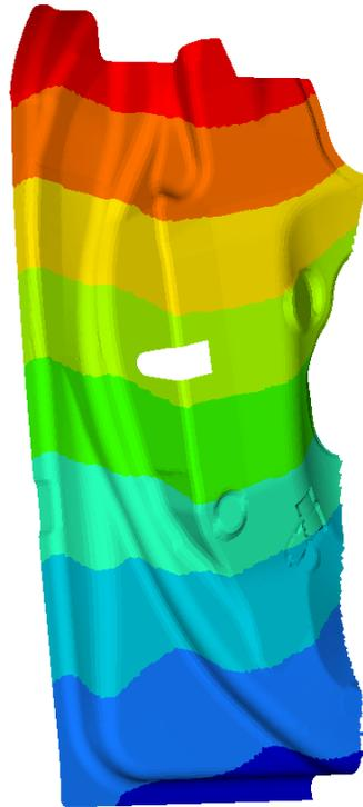
Bild 87. Verschiebung Innenblech-Schloss
