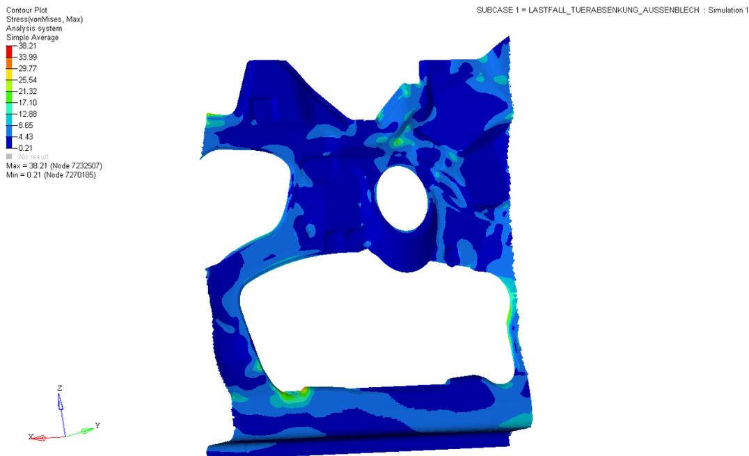
Bild 102. Von-Mises-Vergleichsspannung Innenblech-Mitte
