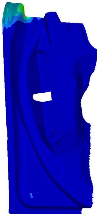
Bild 100. Von-Mises-Vergleichsspannung im Innenblech-Schloss
