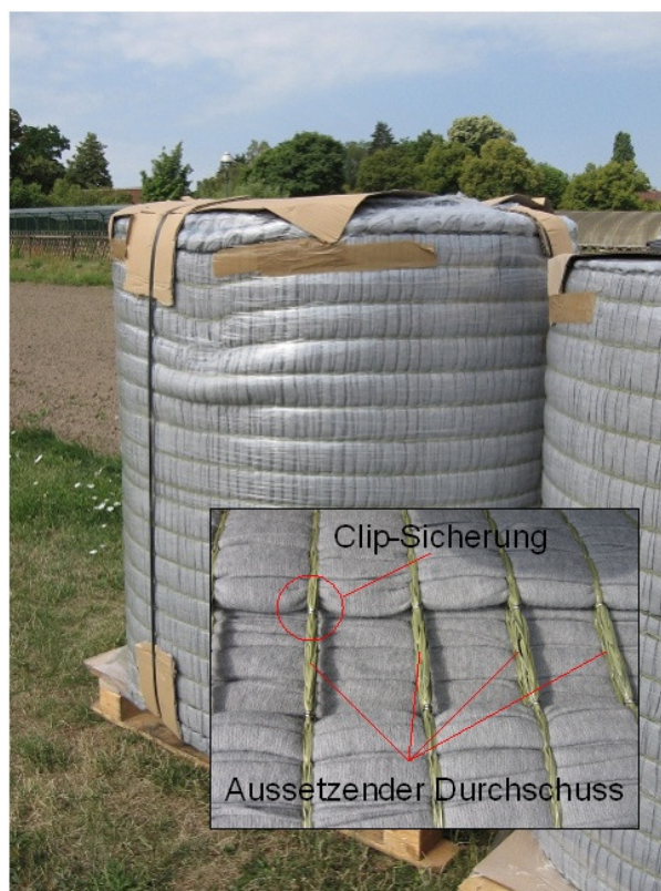
Abbildung 11: Produktions- und transportgünstige „Endlosfertigung“ mit Konfektionserleichterung durch aussetzenden Durchschuss (Fotos: Dr. Christian Schade)
