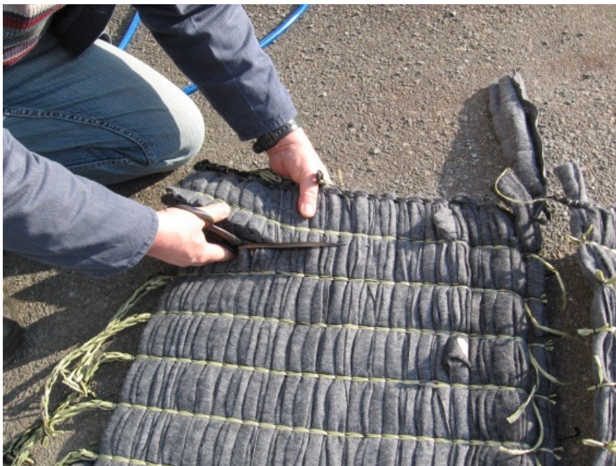
Abbildung 14: Gewirkter Vegetationsträger mit geknautschten Vliesstoffstreifen (grau) im Schuss und verstärktes Foliebändchenmaterial (oliv) als maschenbildendes Grundfadensystem; oben: Konfektion in Längsrichtung; unten: Gefahr des
