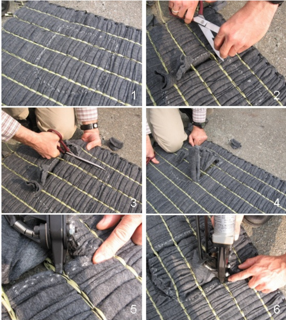
Abbildung 15: (1) Einzeichnen des Ausschnitts; (2) Freilegen des Grundfadensystems ohne das Grundfadensystem zu durchtrennen (3) und (4); (5) und (6) Abriegeln aller Maschen rund um die vorgesehene Ausschnittsstelle
