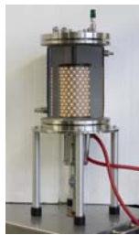
Abbildung 1: Neuentwickelte LED-Beleuchtungseinrichtungen für Umwurfreaktor (links) und Schüttelkolben (rechts) mit entsprechenden Leistungscharakteristika
