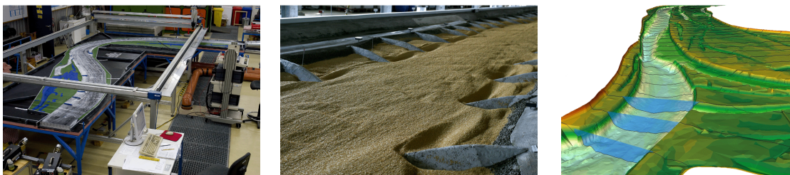
Abbildung 41: Vermessung von Flussbettmodellen
