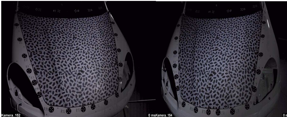
Abbildung 37: Motorhaube mit Textur für PISA-Matching
