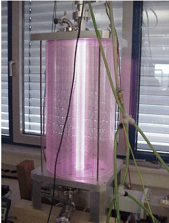
Versuchsaufbau einer linearen Plasmaquelle mit 2 synchronisierten 4 kW Pulsgeneratoren
