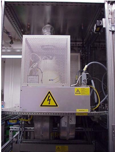
Pulsendstufe mit 5 kW Elektronenröhre
