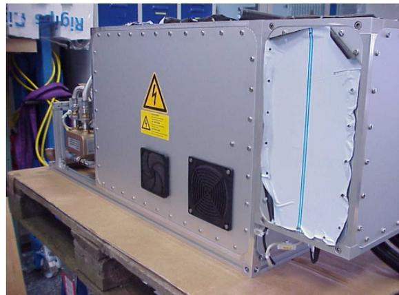
Magnetronkopf für Leistungen zwischen 10 kW und 30 kW (hoher Schirmungsaufwand)
