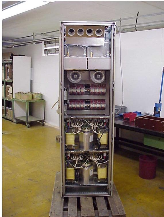
Stromversorgung für 4 Stück 2,45 GHz Magnetrons
