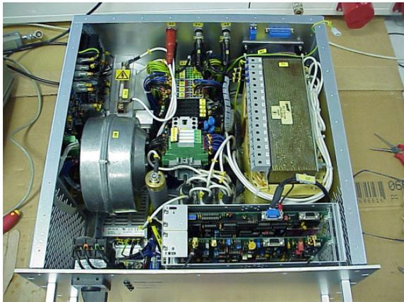
Stromversorgung für 2,45 GHz Magnetron 2 kW CW / 4kW Pulsleistung mit Röhrenendstufe
