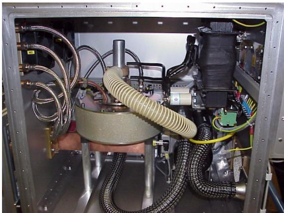
Geöffneter 30 kW Magnetronkopf für 2,45 GHz mit Sicht auf Magnetron und Elektromagnet
