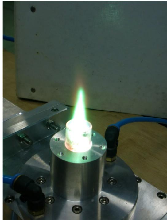
Atmosphären-Plasmaquelle im Betrieb Beimischung von Kupfer-Pulver zur Beschichtung
