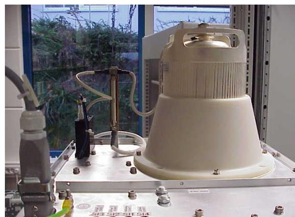
Puls-Endstufe mit luftgekühlter 5 kW-Tetrode
