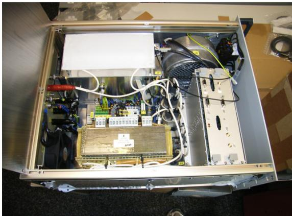
Stromversorgung für Pulsgenerator 5,8 GHz 800 W CW- und 1,6 kW Pulsleistung mit MosFet-Endstufe
