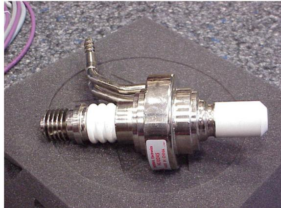
Magnetron 2,45 GHz normale Bauform für den Leistungsbereich 10 kW bis 30 kW
