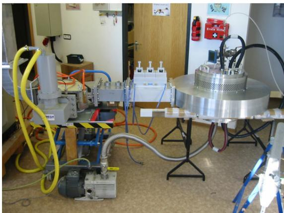
Versuchsaufbau einer 915 MHz Cyrannus Plasmaquelle mit 3-Stub-Tuner zur Abstimmung
