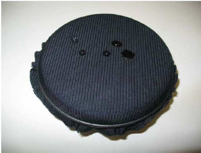
Bild 8: Reibmuster für Martindale - Test
