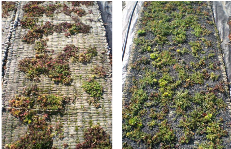
Abb. 8: Deckungsgrad bei unterschiedlichen Auflagen nach 3 Monaten
