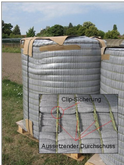
Abb. 7: Produktions- und transportgünstige „Endlosfertigung“ mit Konfektionserleichterung durch aussetzenden Durchschuss
