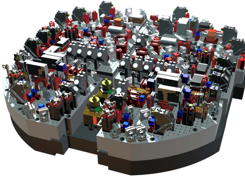
Abbildung II-16: Gesamtlasersystem zum Betrieb der QUANTUS II Apparatur mit Rb und Kalium (dargestellt auf einer Fallturmplattform mit 70 cm Durchmesser)
