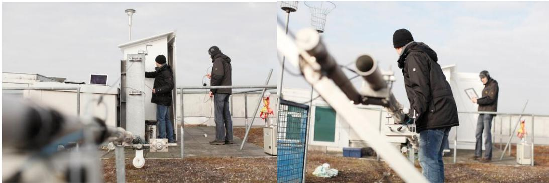
**Abbildung 7: Aufbau eines SOSEWIN-2 Knotens auf dem Dach der Geographie der Humboldt-Universität zu Berlin an einem existierenden Mast für Wettermessungen.**
