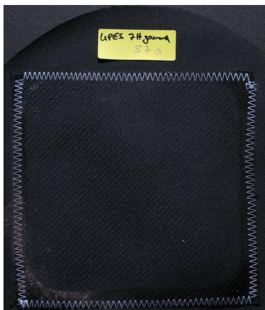
Abb. 91: Farbänderung eines schwarzen Cabriovertop-Untergewebes
