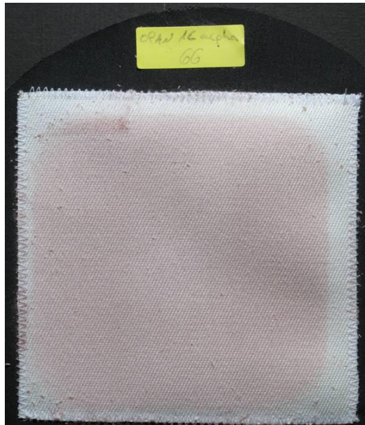
Abb. 90: Anbluten eines weißen Cabriovertop-Obergewebes
