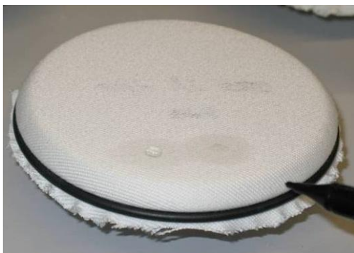
Abb. 85: Tropfentest – verschiedene Tropfen auf einem Gewebe
