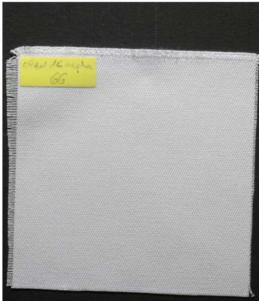
Abb. 90: Anbluten eines weißen Cabriovertop-Obergewebes
