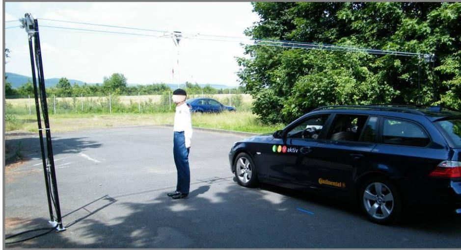
Abbildung 19: Fahrzeugdemonstration mit Fußgängerdummy
