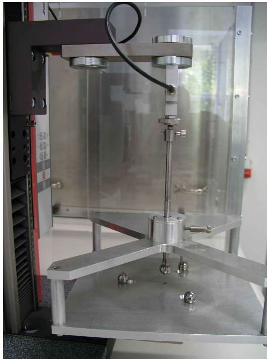
Abbildung 13: Aufbau der Bruchtestapparatur. Die drei unteren Kugel dienen als Auflage für den Wafer, die mittlere Kugel drückt von oben auf den Wafer.
