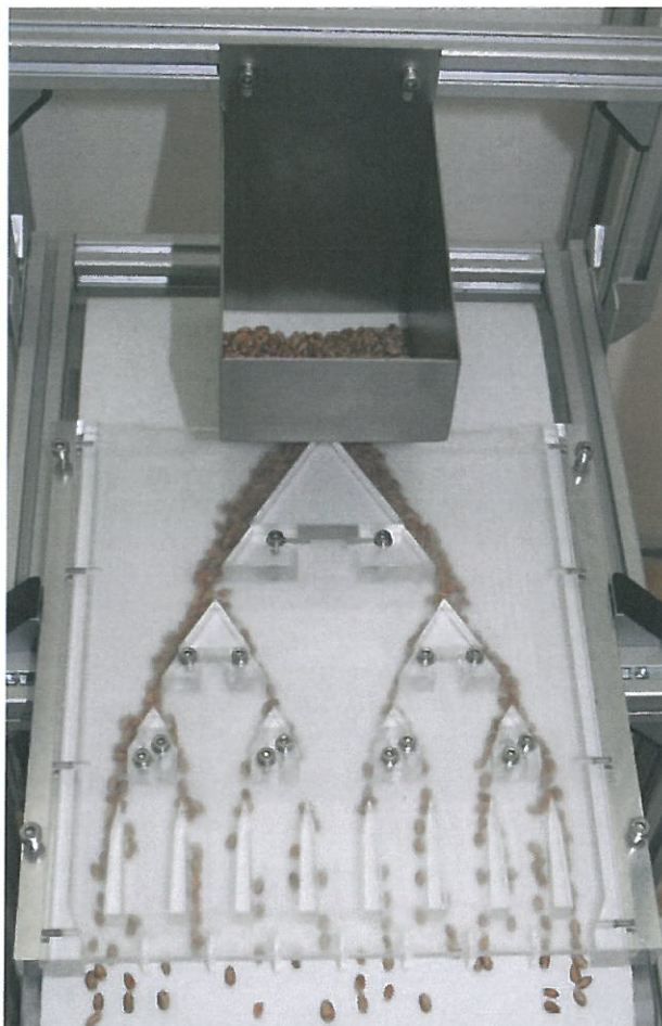
Abbildung 5: Dosier- und Transporteinheit zur zwangsfreien Separation
