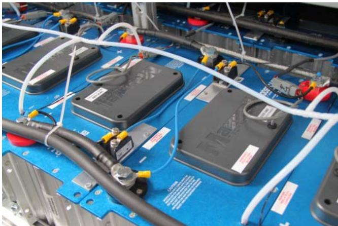
Bild 4: Doppelschichtkondensator-Module als Speicher mit hoher Leistungsdichte in AutoTram
