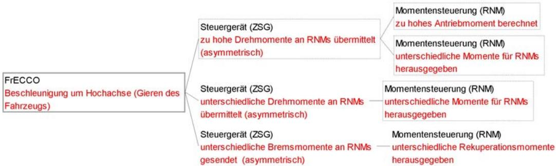
Bild 8: Beispiele für Funktions- und Fehlernetze
