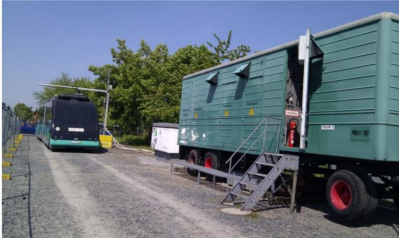
Bild 3: Anfahrt der AutoTram an Dockingstation mit mobilem Unterwerk
