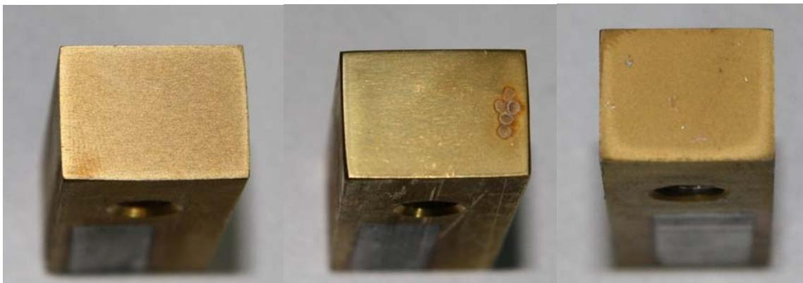
Bild 8: Kontaktfläche einer TiN-beschichteten Stahl-Proben nach einem Stromfluss von 300 A (a; leichte Verfärbung) und 400 A (b), TiN-beschichtete Aluminium-Probe (c)
