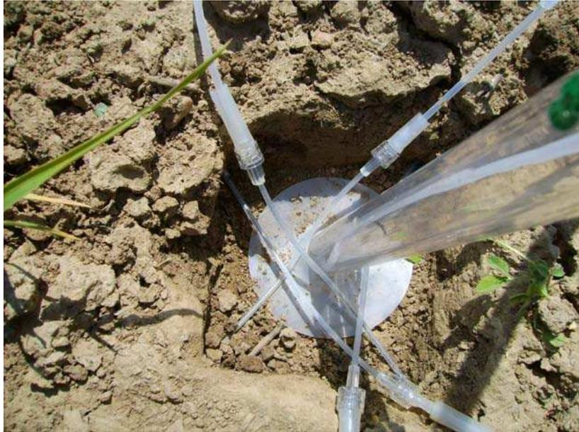
**Abbildung 26: Einbau der Saugkerze (40 cm) und den Mikrosaugwurzeln (5 cm)**
