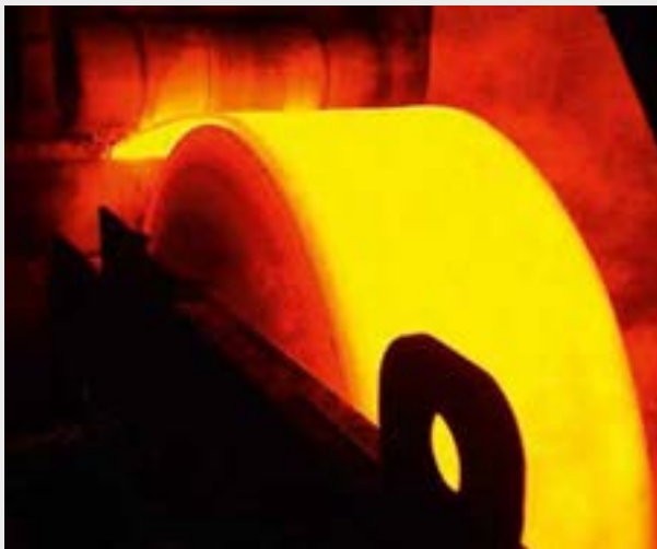
Aufwickeln des gegossenen Stahlbandes (Quelle: Salzgitter Mannesmann Forschung GmbH)
