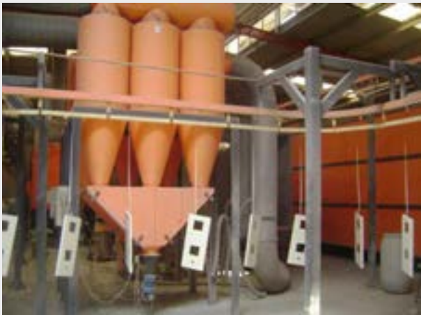
Förderband beim Pulverbeschichtungsprozess (Quelle: Copyright by UNIDO)
