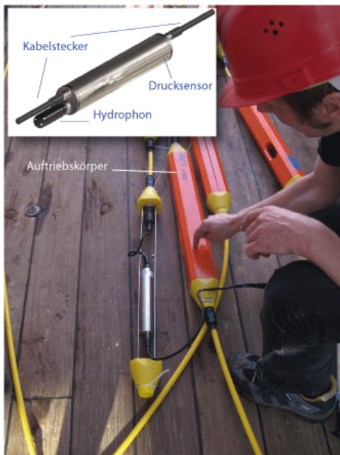
Abb. 13: Hydrophonknoten vor dem Einsatz an Deck des FS SONNE Links gibt ein geöffneter Hydrophonknoten den Blick auf das Druckgehäuse frei. Die Übertragung der Zugkräfte im Streamer wird durch die Metallschienen seitlich am Druckgehäuse gewährleistet. Umschließender Auftriebsschaum (orange) kapselt die Halterung der Hydrophonknoten.
