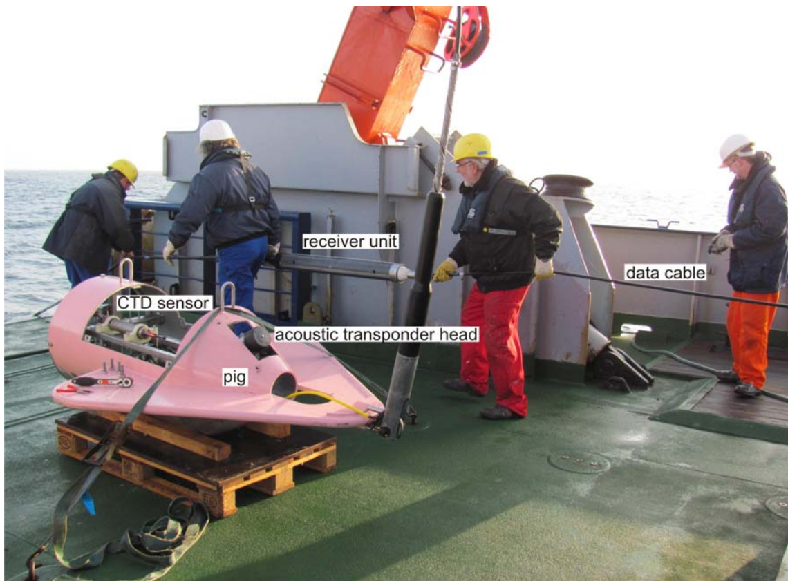
Aussetzen von HYDRA an Bord RV Poseidon. Im Vordergrund das „Pig“ mit Kontrolleinheit, CTD und Akustik-Transponder, im Hintergrund eine Empfangseinheit zwischen Datenkabeln.
