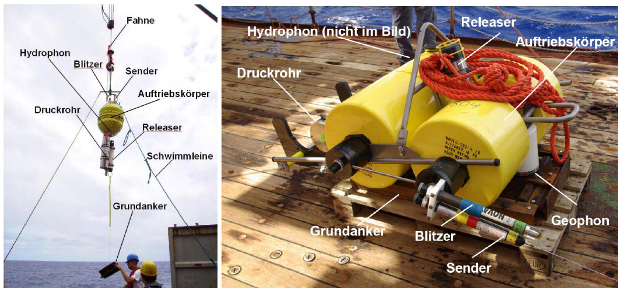
Abbildung 5.1: links: Komponenten eines Ozean-Boden-Hydrophon (OBH), kurz vor dem Aussetzen rechts: Ozean-Boden-Seismometer (LOBSTER), kann bis zu einer Wassertiefe von 8000 m operieren.
