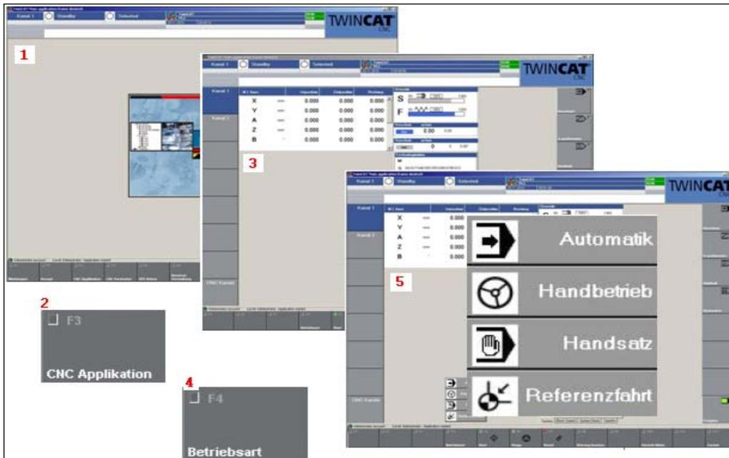
Abbildung 90 - Starten der HMI-Oberfläche
