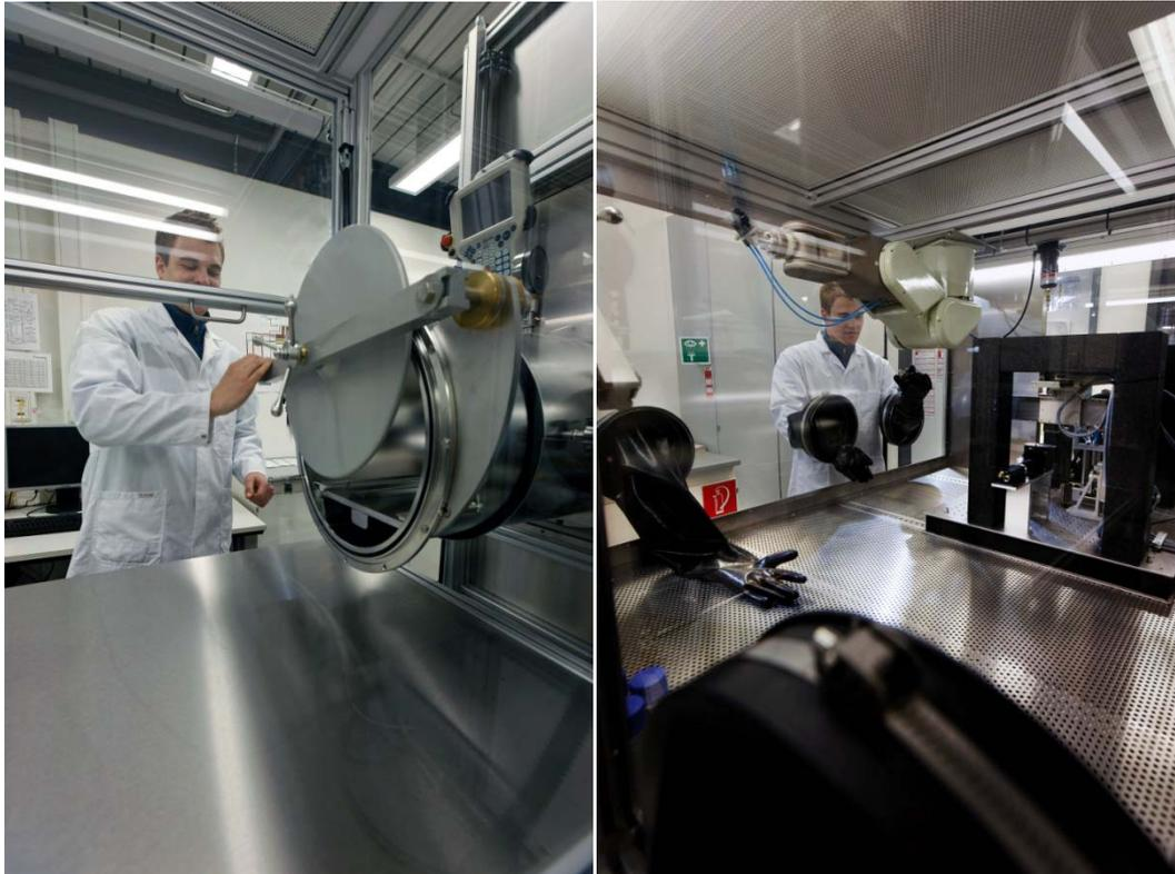
**Abbildung 5 - links: Schleuse zwischen Reinraumbox und Cleanbench, rechts: Blick durch die Reinraumbox auf die Handschuheingriffsöffnungen und die Dosierkinematik mit Granitaufbau**
