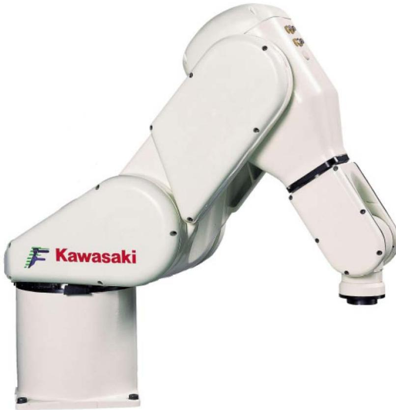
**Abbildung 54 - Handlingsroboter (Kawasaki)**
