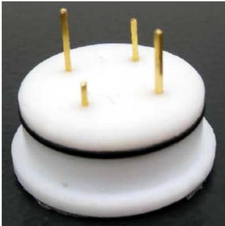
**Abbildung 37 - Deckel des Reservoirs mit Füllstands-Messung**
