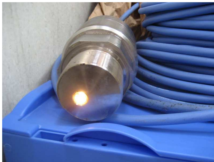
Abbildung 18: Aktiver Spektroskopie-Messkopf [eigene Darstellung]
