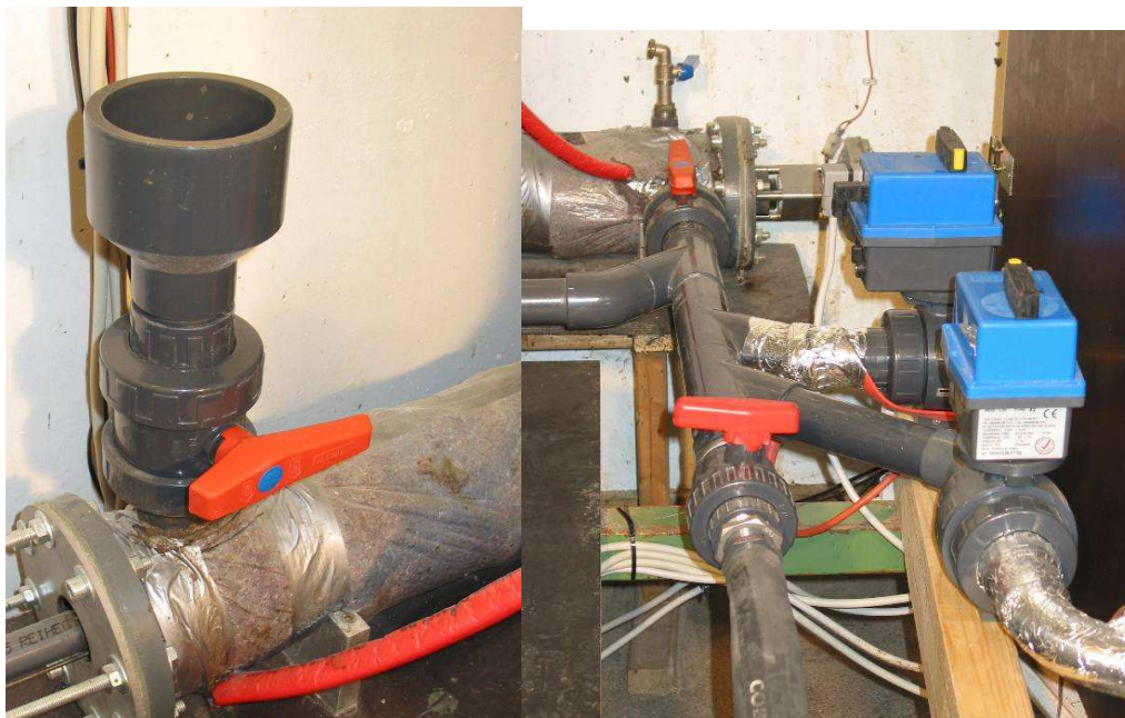
Abbildung 56: Automatisierte Dosier- (links) und Einbringtechnik (rechts, eigene Darstellung)
