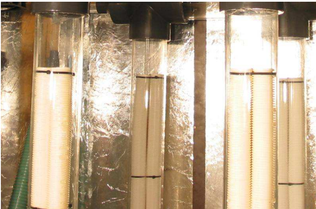
Abbildung 52: Upflowfermenter (links) und Downflowfermenter jeweils mit Festbettstrukturen (eigenes Bild)
