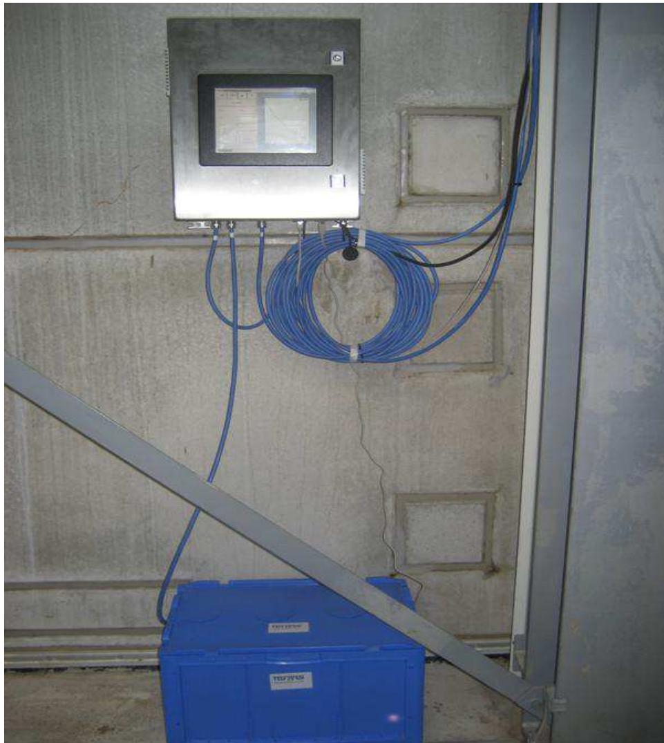
Abbildung 30: Auswerteeinheit mit Box für den „Offline – Messkopf“ [eigene Darstellung]
