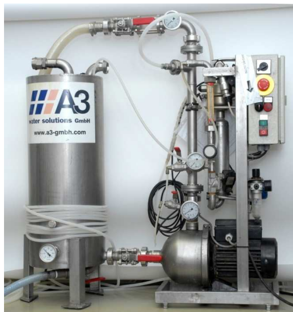
Abbildung 7: Ultrafiltrationsanlage mit einem Fassungsvermögen von 30 Litern
