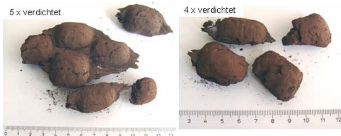
Abbildung 111: Presslinge der 5. und 4. Verdichtungsstufe hergestellt mit Stahlwalzen
