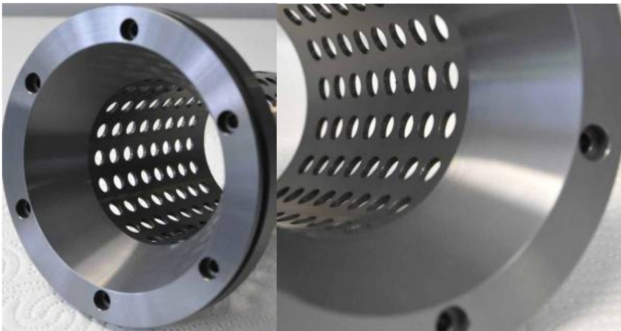
Abbildung 13: Kammerstück mit neuer Hartstoffbeschichtung
