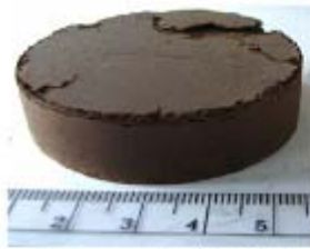
Si-Granulat bei 1000°C Pressdruck 140 MPa Pressdauer 5 s
