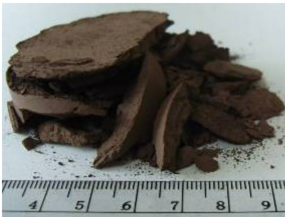
Abbildung 66: Charakteristisches Erscheinungsbild eines Si-Presslings
