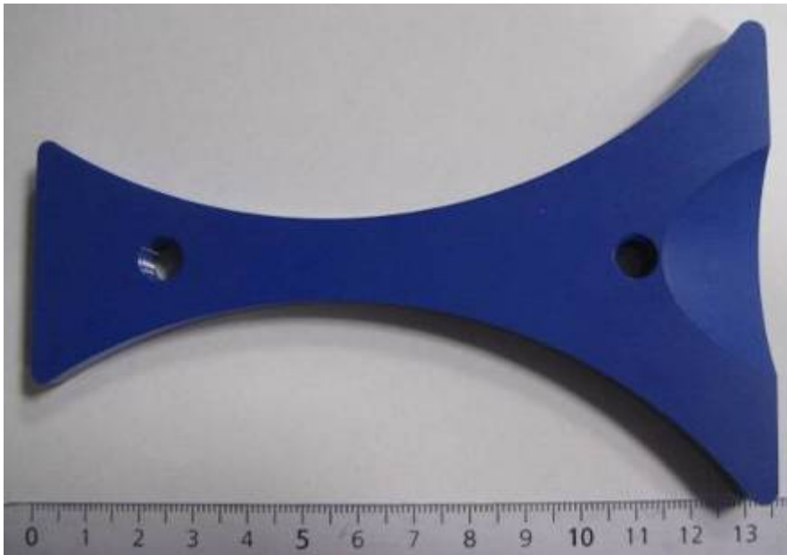
Abbildung 14: Herzstück aus Keramik 3 vor dem Einsatz
