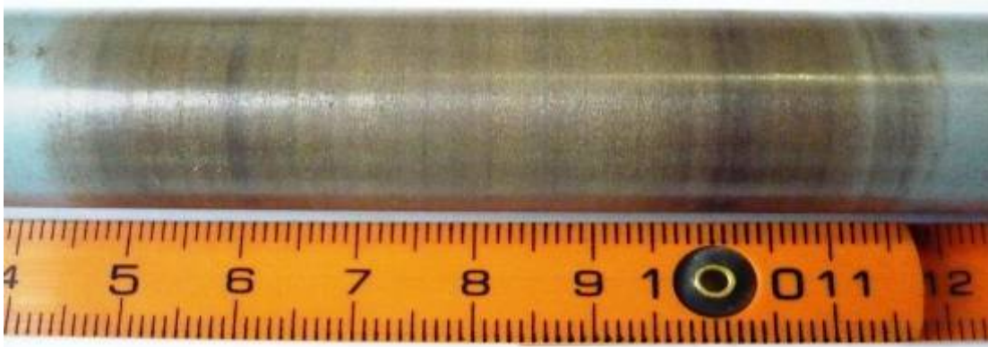
Abbildung 150: \text{Si}_3\text{N}_4 -Stab nach Verschleißversuch
