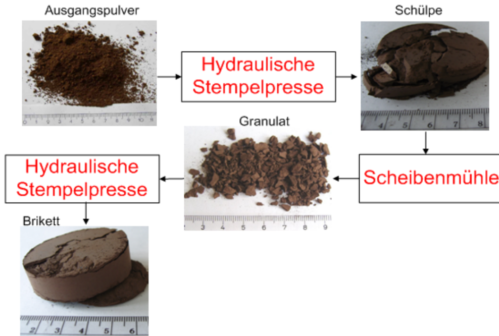
Abbildung 70: Vorgehensweise bei den Pressversuchen mit Vorgranulierung
