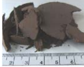
Si-Pulver bei Raumtemperatur Pressdruck 140 MPa Pressdauer 5 s
