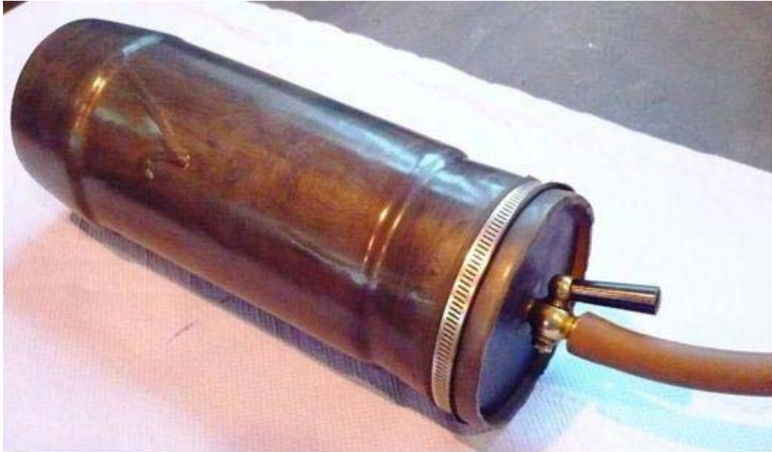
Abbildung 146: Befüllte Formenhülle während der Evakuierung
