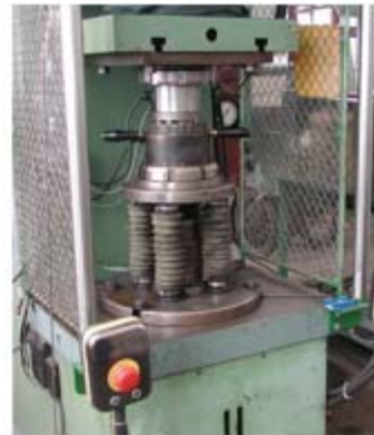
Abbildung 65: Schematische Darstellung der Presswerkzeuge und Foto der hydraulischen Stempelpresse
