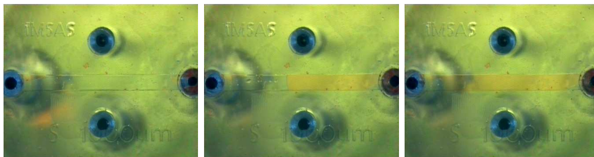
Abbildung 25 Fluss durch den PDMS-Kanal
