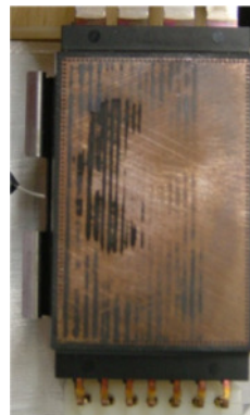
Abbildung 38: Thermische Untersuchung der Moldmodule; Korrelation mit Kontaktabdruck der Wärmeübergangsschicht;
