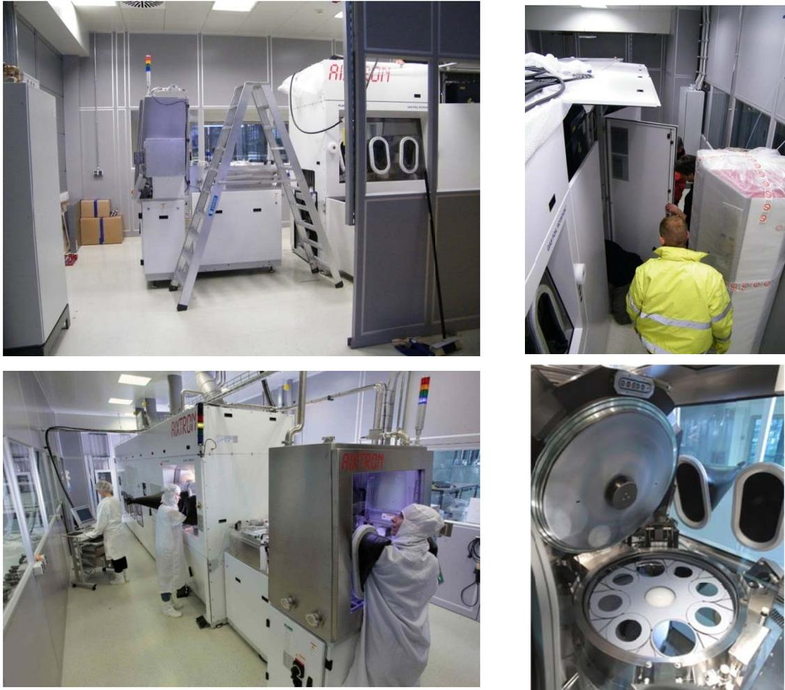
Abbildung 3.11: Laborerweiterung des MOVPE-Labors mit dem G4 MOVPE Reaktor inkl. Roboter (obere Reihe). Blick auf den im Betrieb befindlichen G4 Reaktor (unten links) und in den geöffneten Reaktor (unten rechts) der mit insgesamt 8 Substraten mit 2, 4 oder 6 Zoll Durchmesser bestückt werden kann.
