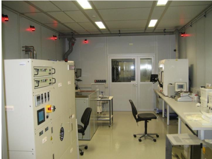
*Abbildung 3.13: Bonderlabor des Fraunhofer ISE. Vorne links steht die „SAB 100“ Bondkammer von Ayumi, hinten links, die Nassprozessanlage „OPTIwet ST30“ und hinten rechts die Logitech „Tribo“ für die chemisch mechanische Politur von Oberflächen.*
