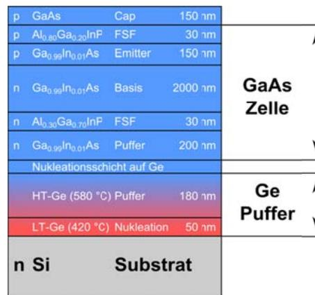
Abbildung 3.42: Schematischer Schichtaufbau der GaAs-Einfachsolarzelle auf einem Ge-Puffer auf Si-Substrat.
