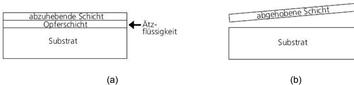
Abbildung 3.90: Der nasschemische Lift-Off beruht auf dem selektiven Ätzen der Opferschicht (a). Dadurch kann eine dünne, kristalline Schicht vom Substrat abgehoben werden (b).
