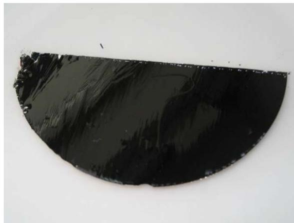
Abbildung 3.97: Abgehobene, mit Cu stabilisierte Halbleiterschicht auf Sägefolie nach 6-stündigem, gewichtsunterstützten Lift-Off-Prozess in 5-prozentiger Flußsäure.
