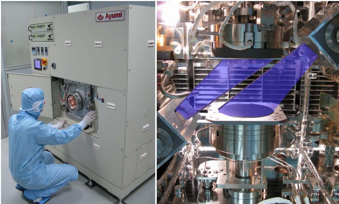
Abbildung 3.102: Fotos des am Fraunhofer ISE installierten Wafer-Bonders. Das rechte Bild zeigt die Bondkammer. Der Verlauf der Argonatomstrahlen ist in blau eingezeichnet.
