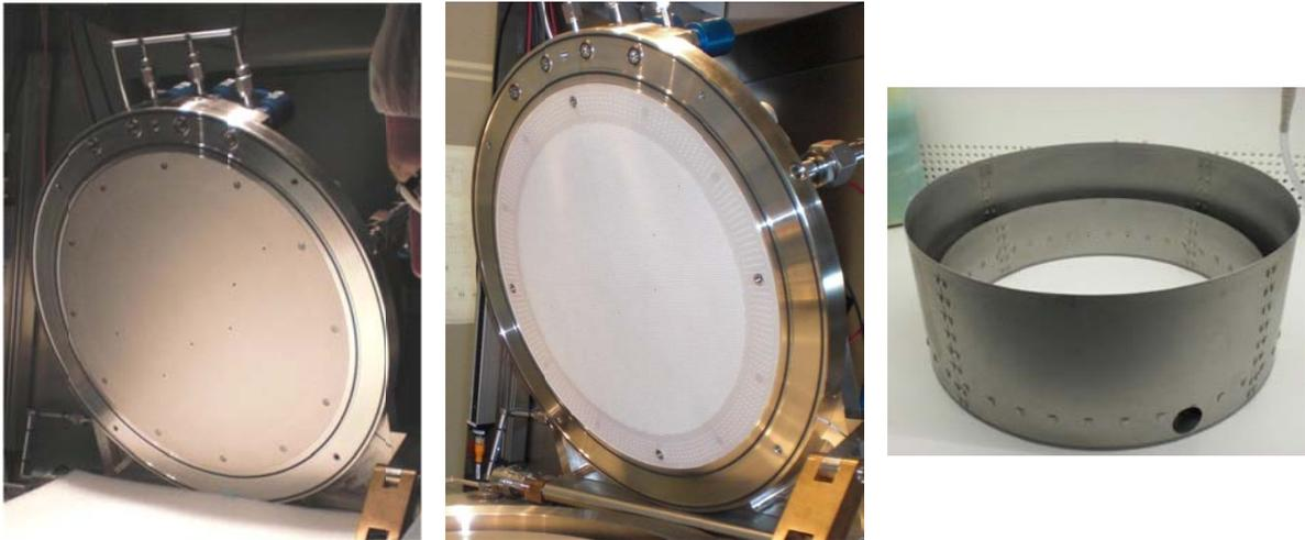
Abbildung 3.4: Bilder des Reaktordeckels ohne bzw. mit Quartz-Ceiling (links bzw. Mitte) und des Abgaskollektors aus Molybdän.
