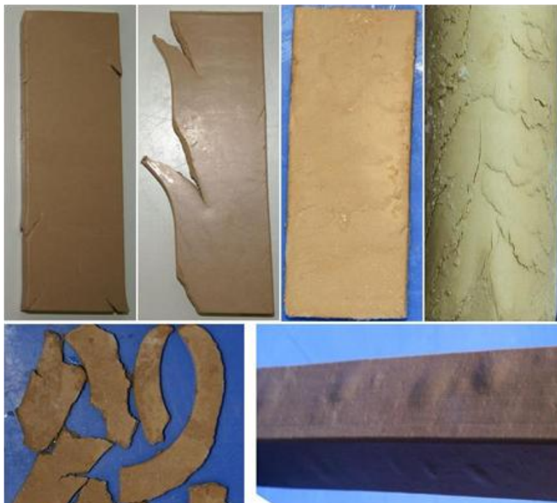
Abbildung 18: Beispiele für Pressfehler (Ausschnitt aus dem Fehlerkatalog): Oben von links nach rechts: Drachenzähne (leicht und stark), Laminierungen und Schuppen in der Oberfläche, unten links: Instabilität und Rissbildung, unten rechts: Blasen im Strang
