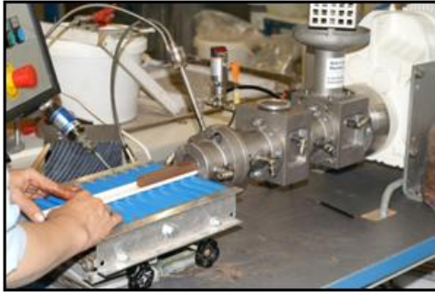
Abbildung 17: Der VAR 50A/50 Laborextruder im Einsatz
