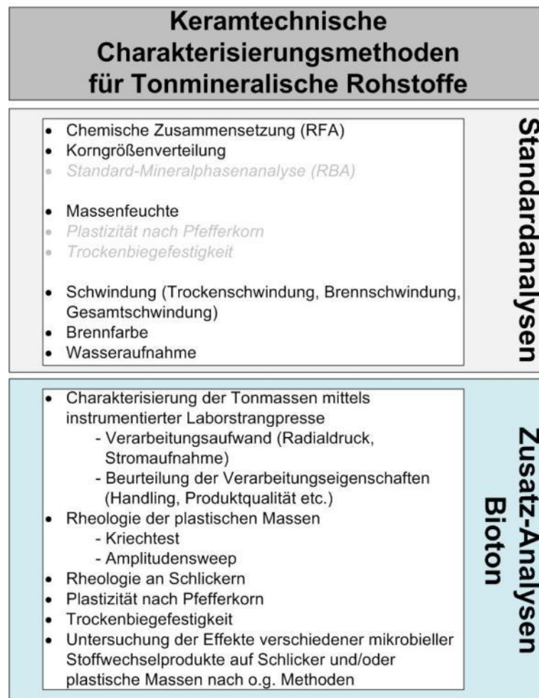
Abbildung 16: Übersicht der keramtechnischen Charakterisierungsmethoden (Standard und Bioton; grau hinterlegt: Standardmethoden, die aber nicht bei allen Rohstoff- bzw. Masseproduzenten eingesetzt werden)
