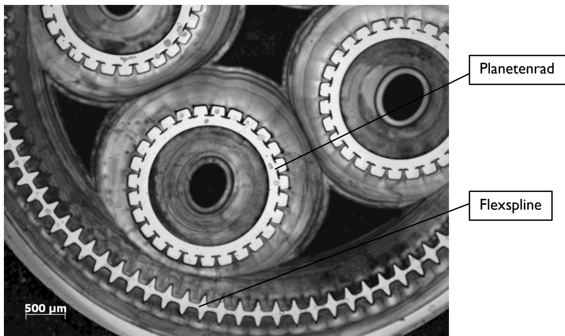
Abb. 7-18: Planetenrad und Flexspline (eingebettet)
