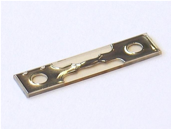
Abb. 3-31: Mikrozugprobe mit „Überwachungen“ nach Entnahme vom Wafer
