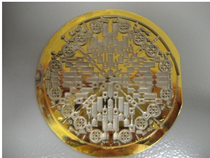
Abb. 3-26: Mit dem Direkt-LIGA-Verfahren abgeschiedene Mikroproben und Mikrozahnräder auf einem Siliziumwafer
