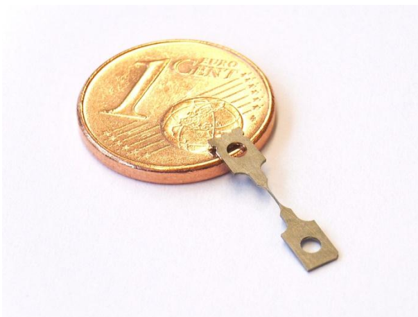
Abb. 3-36: Fertig nachbearbeitete und gereinigte Mikrozugprobe
