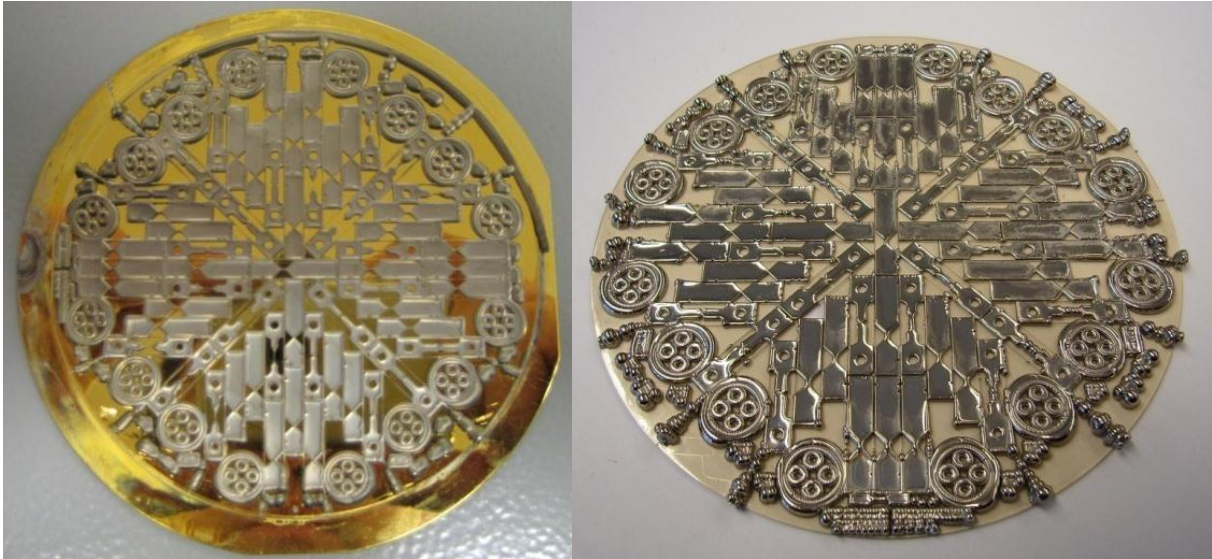
Abb. 3-30: Wafer nach Entnahme aus der Galvanik (links), Bauteile und Mikroproben umgeben von der Resiststruktur, ohne Si-Wafer (rechts)
