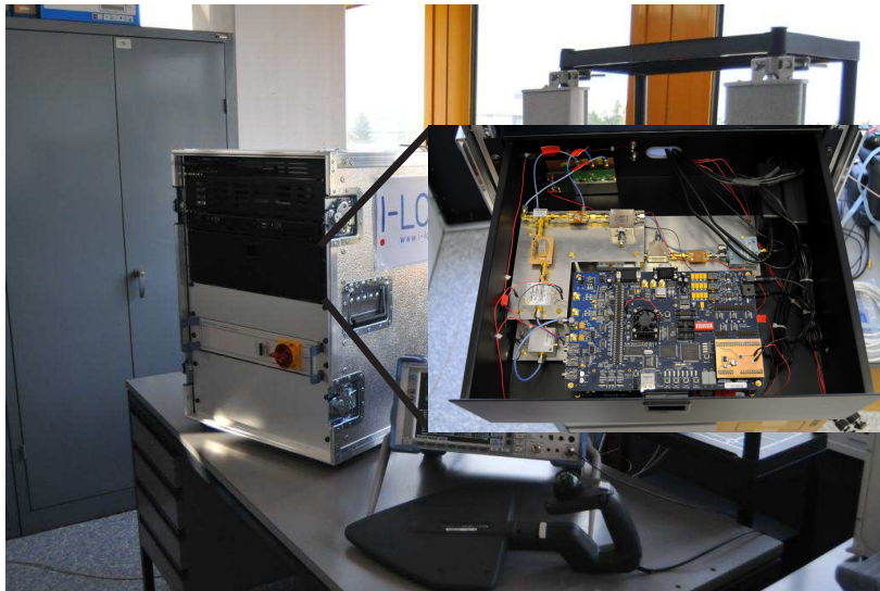
Abbildung 10: Hardwareaufbau der I-LOV BTS mit dem GSM-Jammer
