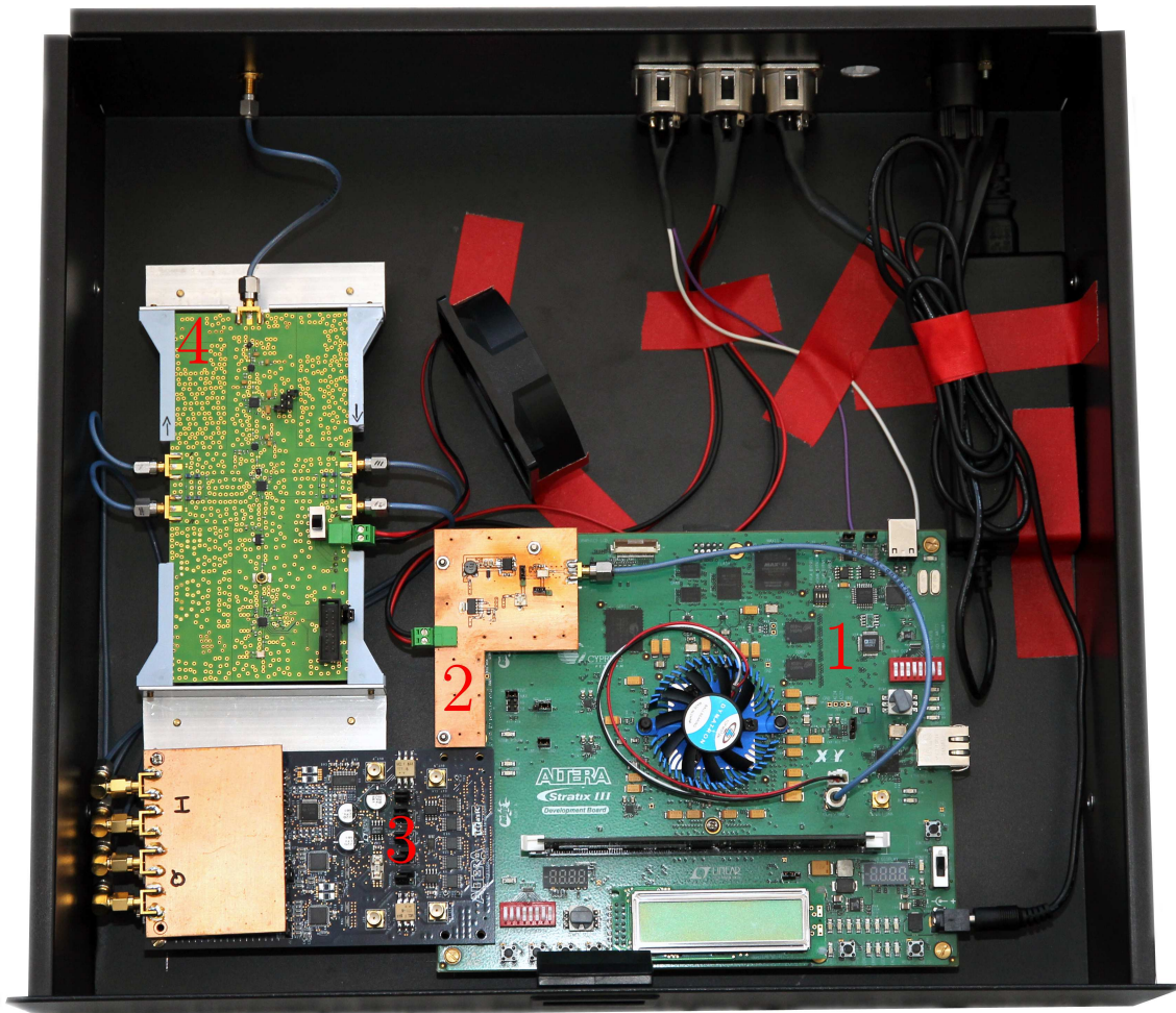
Abbildung 15: Aufbau des UMTS-Jammers im I-LOV-Rack: 1) FPGA-Signalgenerator; 2) Abtastakterzeugung; 3) ADU-Adapterplatine; 4) HF-Frontend.
