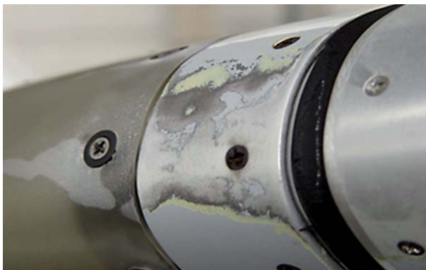
Abb. 2 d): Beispiele für Erosionsschäden: Vorderkante Tragfläche, erosiver Verschleiß der Außenlackierung
