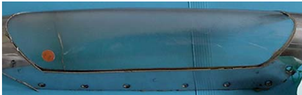
Abb. 2 b): Beispiele für Erosionsschäden: Positionslicht Flugzeug, Transmissionsabnahme durch Erosion
