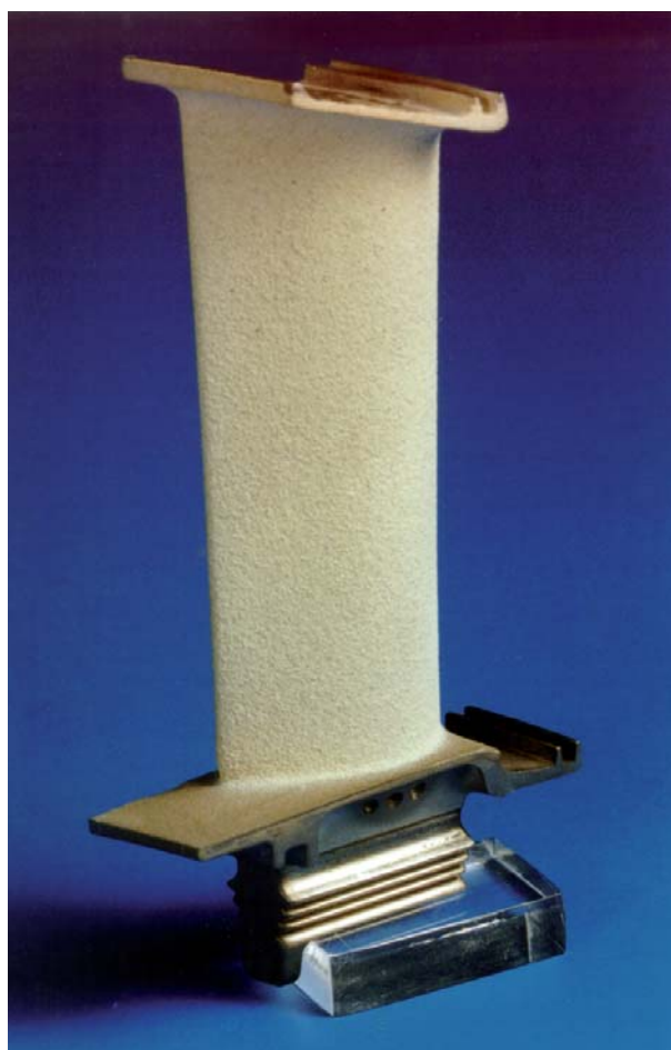
Abb. 4: Beschichtete Turbinenschaufel (LWT, Universität Dortmund)
