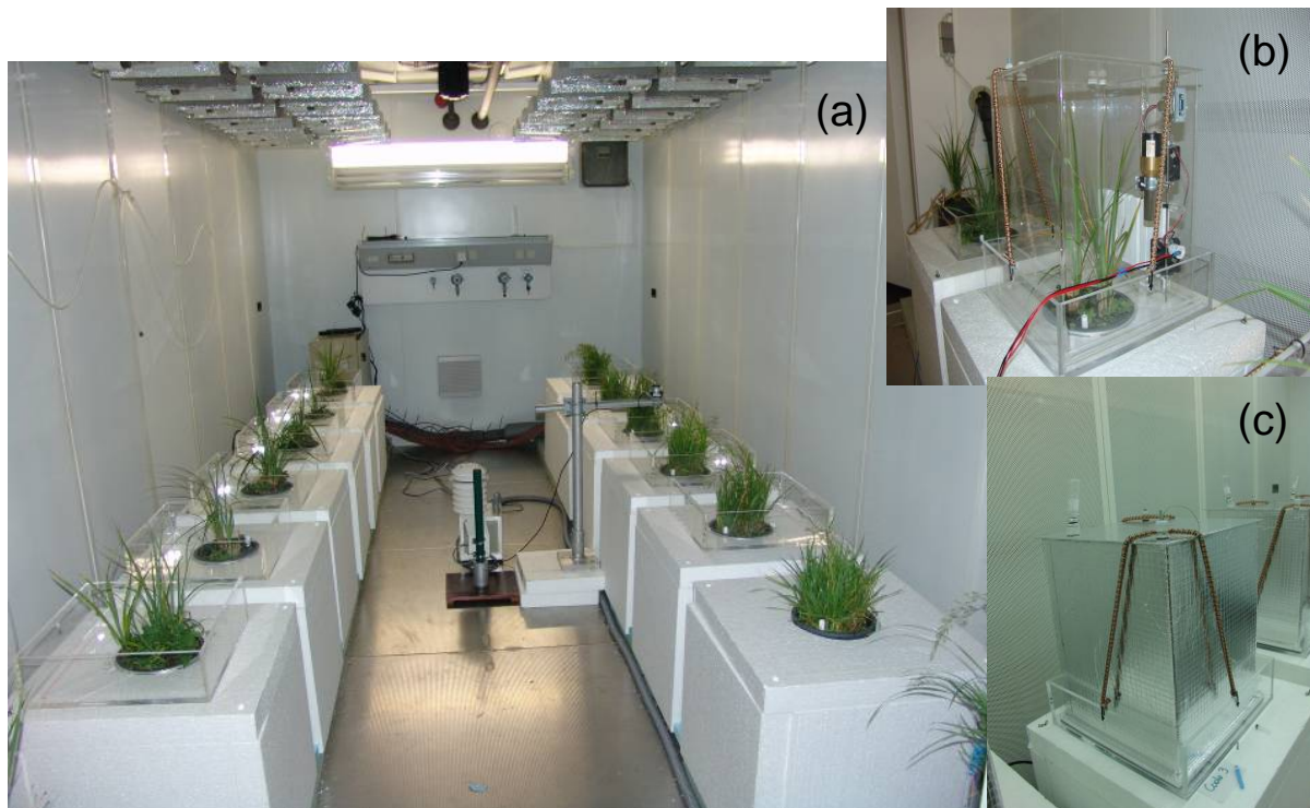
Abb. 33: Experimenteller Aufbau in der Klimakammer: intakte Moorsäulen mit Vegetation mit Isolation und Kühlung (a), Messkammern für Messung des \text{CO}_2 -Austausches (b) Netto-Ökosystem-Austausch und c) Ökosystematmung). (Fotos: Maria Hahn-Schöfl)
