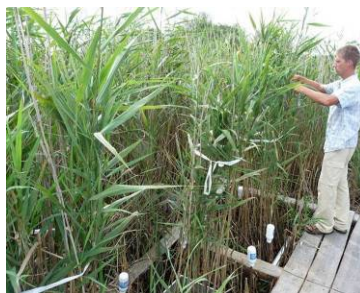
Abb. 71: Messplot zum Erfassen des Gasaustausches auf einem überstauten Torfstich in Weißrussland
