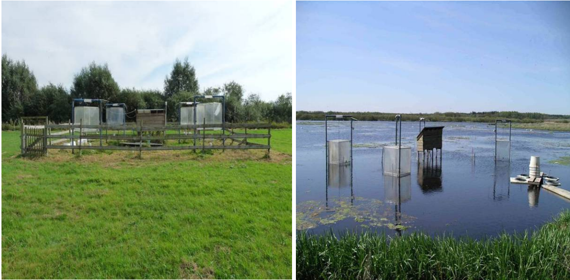
Abb. 3: Wechselfeuchte Messfläche Z1 und überstaute Messfläche Z2 am Standort Zarnekow (TG3) mit automatischer Hubküvettenanlage zur Erfassung des Netto-CO 2 -Austausches
