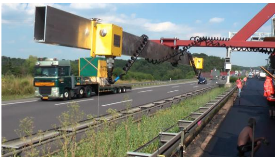
Abb. 26: Realisierte Schichtdickenmessung für die Deckschicht
