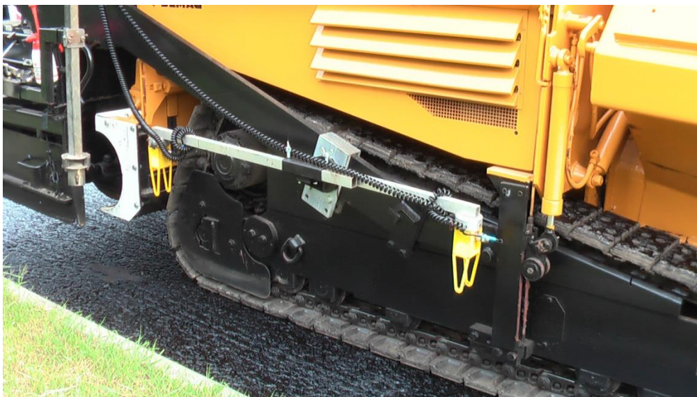
Abb. 83: Sensoren für Schichtdickenmessung
