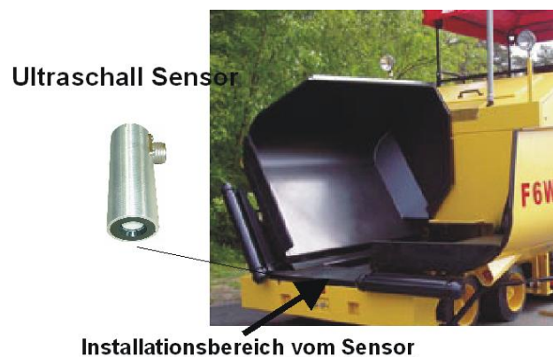
Abb. 4: Sensoranbringung am Fertiger
