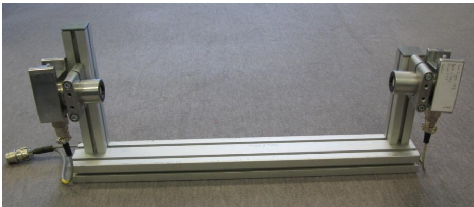
Abb. 11: Messaufbau zur Kontrolle für Ultraschallsensoren
