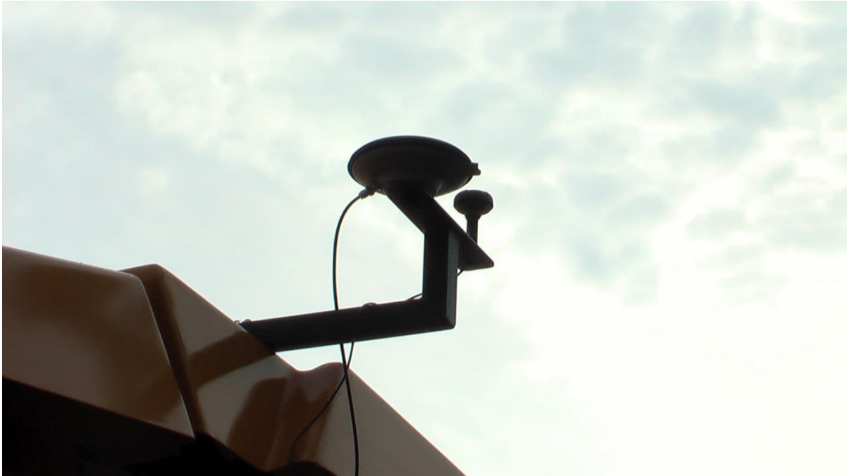
Abb. 62: Zwei getrennte GPS – Antennen für Positionsbestimmung
