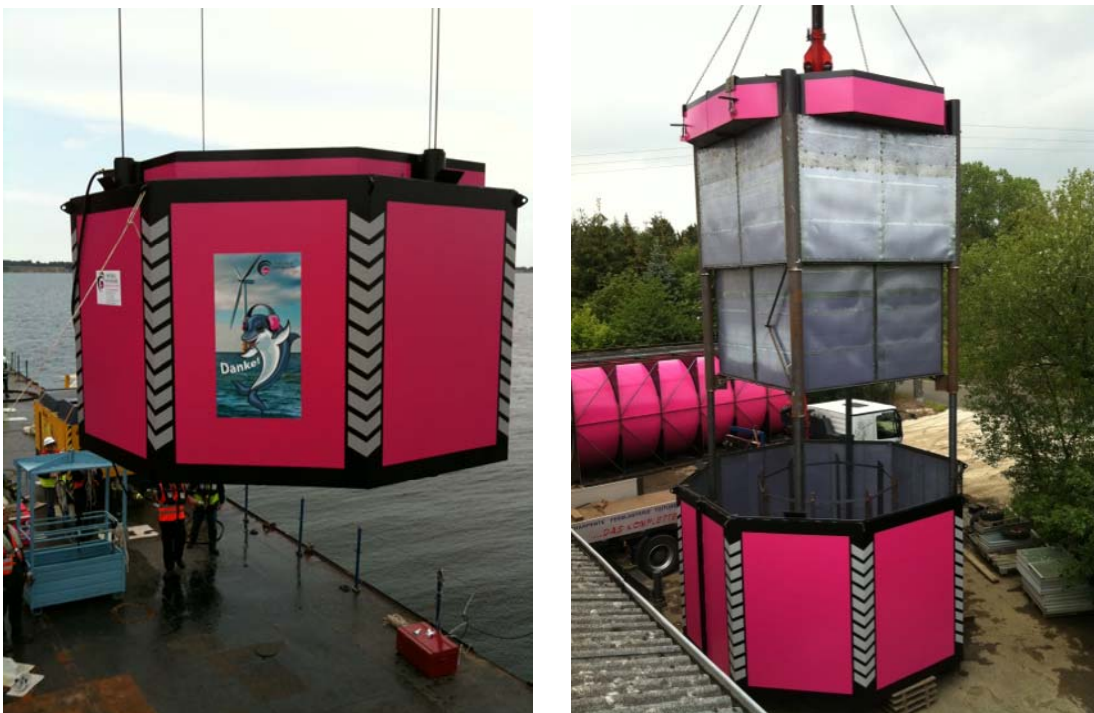
Abbildung 18: Eingefahrenes und teleskopisch ausgefahrenes LBC-System (Foto links: Patrice Kunte, Foto rechts: Weyres)
