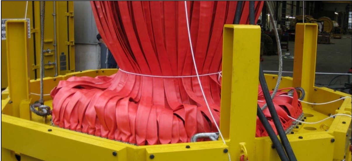
Abbildung 15: Detailaufnahme des unteren Endes des NMS mit den Anschlüssen der Feuerwehrschräuche (Foto: Patrice Kunte)
