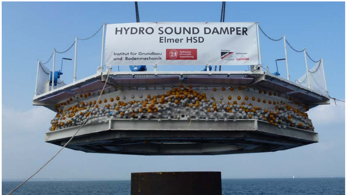
Abbildung 31: Die gesamte HSD-Plattform über dem Testpfahl (Foto: Patrice Kunte)
