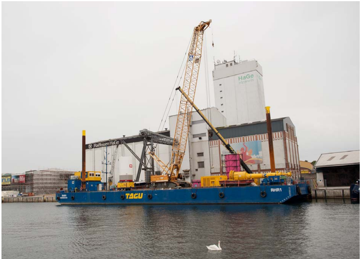
Abbildung 8: Stelzenponton RHR 1 mit Ausrüstung (Foto: Patrice Kunte)
