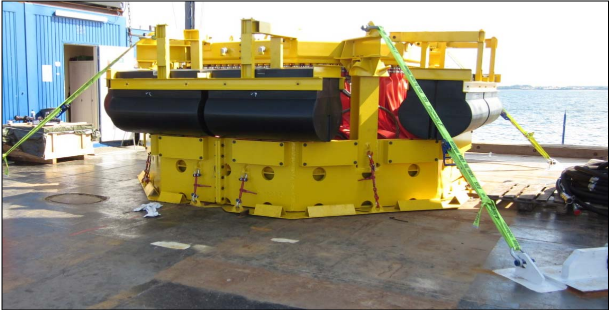
Abbildung 16: Seafastening des Feuerwehrschauch-Systems (Foto: Patrice Kunte)
