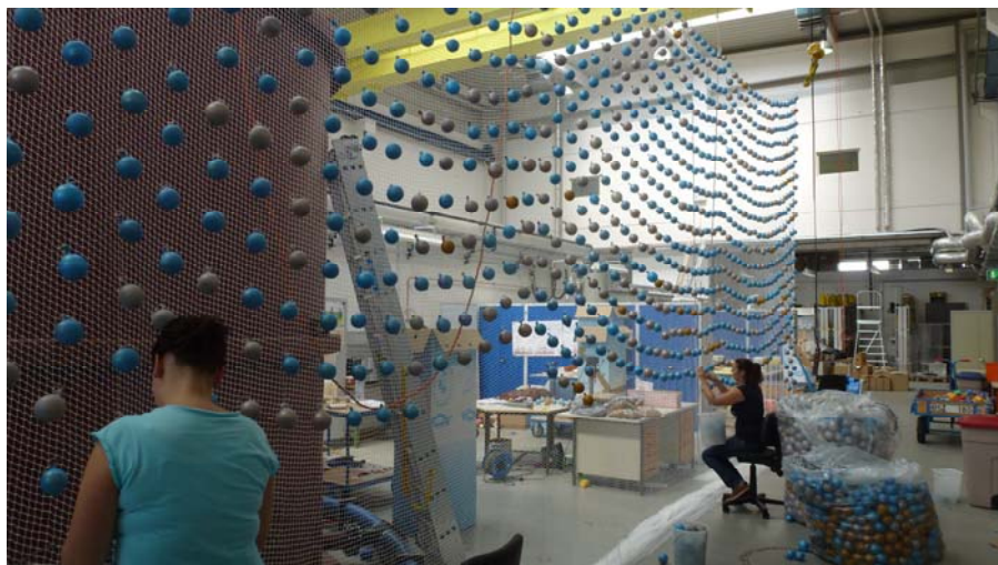
Abbildung 28: Fertigung des inneren Netzes mit doppellagigen luftgefüllten HSD-Ballons (Quelle: TU Braunschweig/Dr. Elmer)
