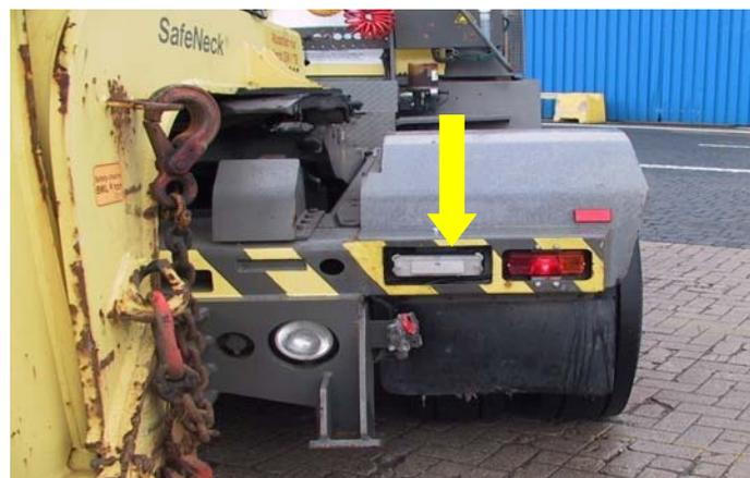
Abbildung 2-40: Eingebauter RFID Reader in der Zugmaschine
