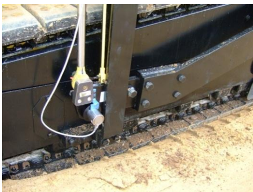
Abbildung 23: links: Scherkraftmessbolzen am Anlenkpunkt rechts: gemessene Bohlenzugkraft
