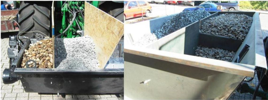
Abbildung 39: Aufteilung des Behälters quer (links)/ und längs (rechts)
