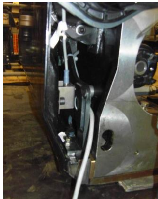
Abbildung 32: Versuchsaufbau um Reibungsverluste zu erfassen
