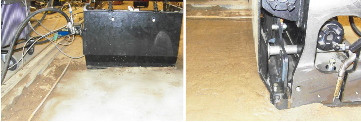
Abbildung 34: Versuchsaufbau zur Verdichtung von feuchtem Lehm
