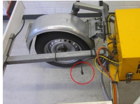
*Bild A-8: Temperatursensor zur Erfassung der Lufttemperatur*
