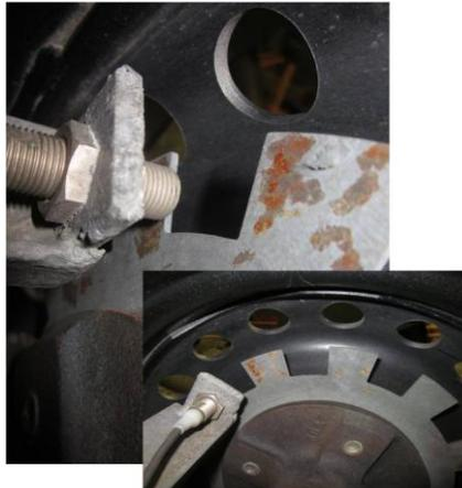
*Bild A-11: Impulsgeber zur Erfassung der Messgeschwindigkeit des Triebfahrzeuges*
