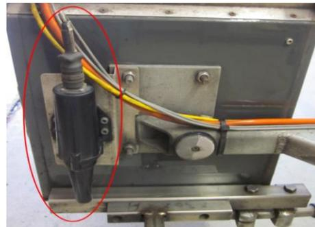
*Bild A-10: Temperatursensor zur Erfassung der Oberflächentemperatur*
