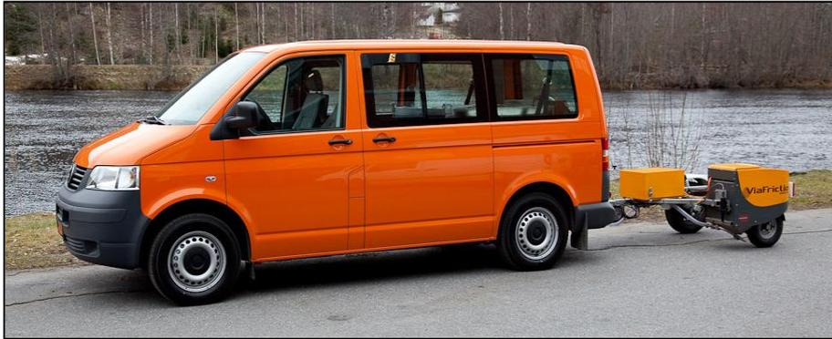
*Bild 3-11: Griffigkeitsmesssystem ViaFriction*
