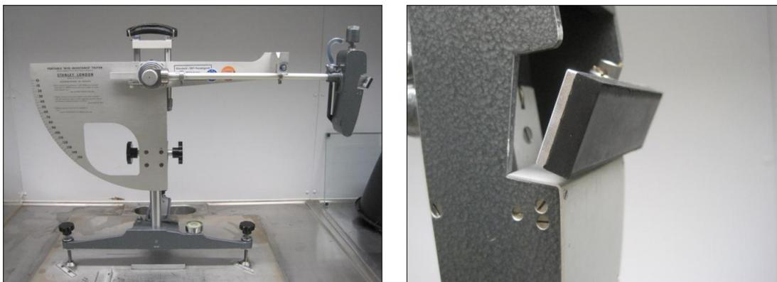
*Bild 3-8: SRT-Pendelmessgerät (links) und Gleitgummi (rechts)*
