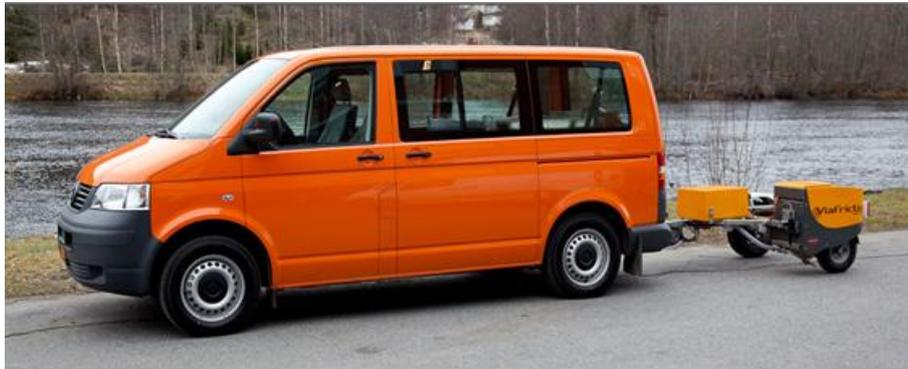
*Bild A-1: Messgespann bestehend aus Zugfahrzeug und Messeinheit*
