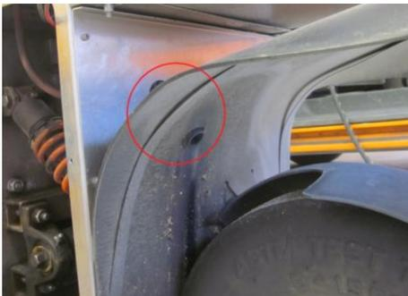
*Bild A-9: Temperatursensor zur Erfassung der Reifentemperatur*
