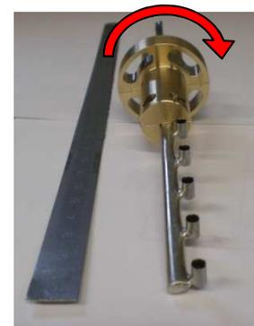
**Abbildung 4.5:** Winkeltoleranzbereich der Totaldrucksonde 2, Messstelle 3
