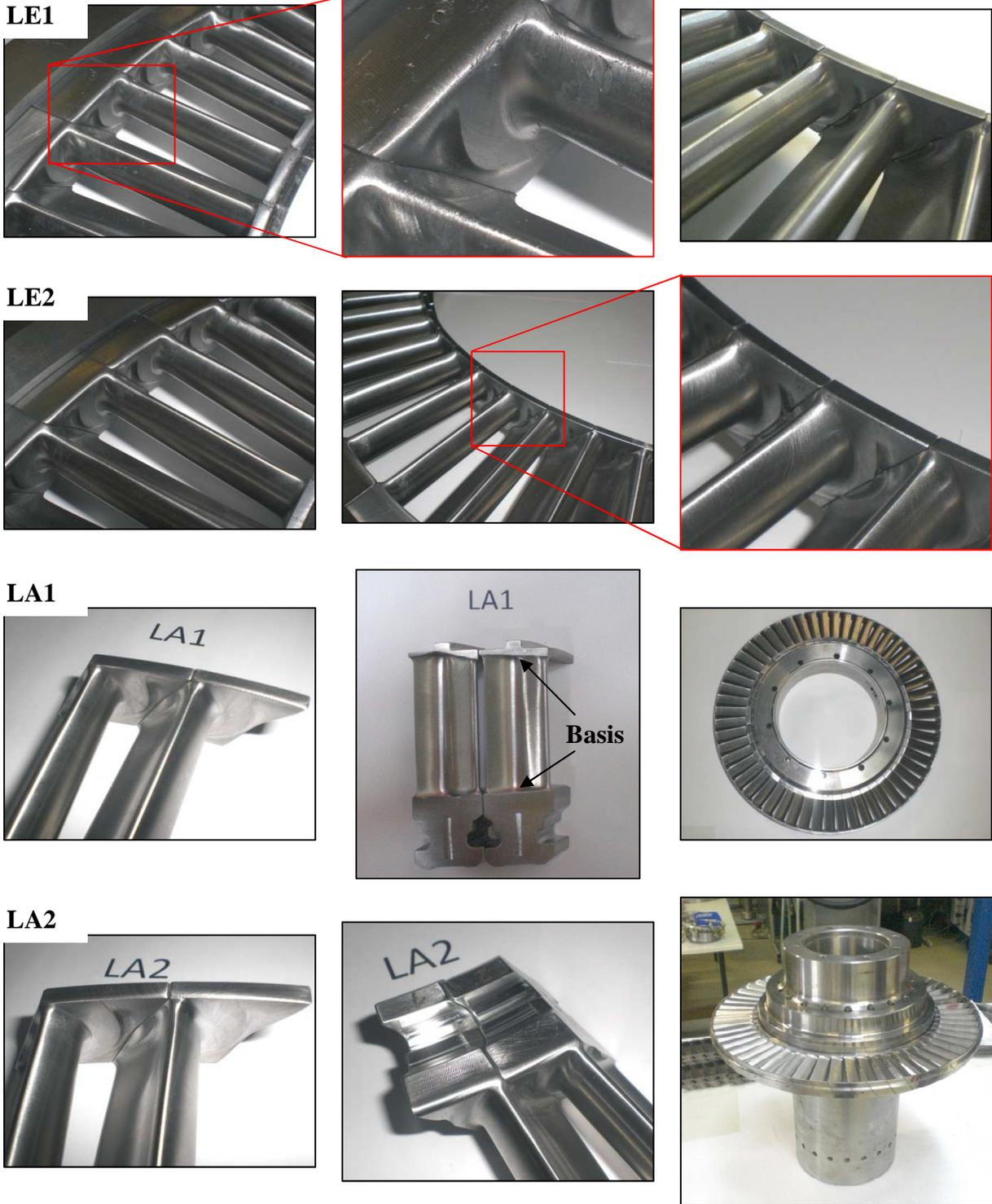
Abbildung 2.13: Prototyp der Konturierung für die zweistufige Testturbine
