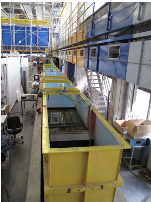
Abbildung 4.1: „Gelbe“ Kipprinne in der Versuchsanstalt für Wasserbau
